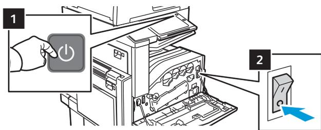
Pour redémarrer l'imprimante, appuyez sur l'**interrupteur d'alimentation secondaire** sur le panneau de commande.
