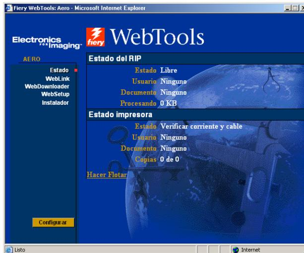
Para abrir una nueva ventana de examinador para Estado, haga clic en Flotante. Ahora puede cerrar todas las demás ventanas de examinador y dejar abierta la ventana Estado para seguir comprobando el estado del EX7750. La ventana de Estado se actualiza automáticamente mientras permanezca abierta.
