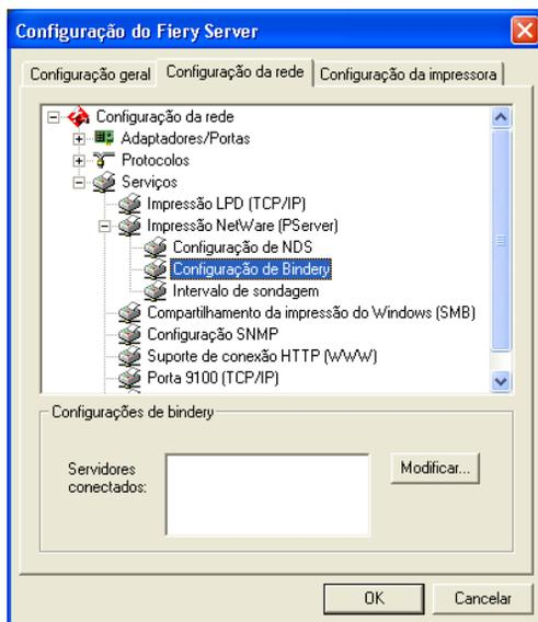
Para adicionar, remover ou alterar as conexões de bindery, clique em Modificar e especifique as configurações na caixa de diálogo Conexões de bindery, conforme descrito nos procedimentos a seguir.
