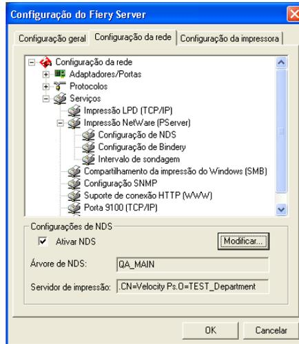
**PARA ESPECIFICAR A CONFIGURAÇÃO DA ÁRVORE DE NDS A PARTIR DA CONFIGURAÇÃO REMOTA DO EX7750**
