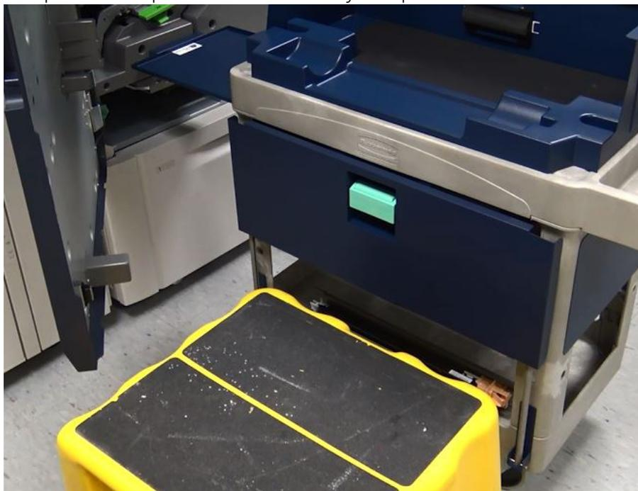
23. Mientras presiona el enganche del riel, levante la parte delantera del conjunto y deslícela hacia adelante.
