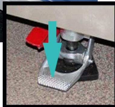
**!** **Precaución:** Para el siguiente paso, cuando se suelta el enganche de la puerta inferior, la puerta descende de repente. Sujete la manija de la puerta y deslice la puerta hacia abajo hasta su posición.
