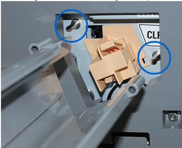
2. Presione la pestaña de liberación de la parte delantera del corotrón de carga y tire hacia fuera hasta que el corotrón encaje en la guía.
