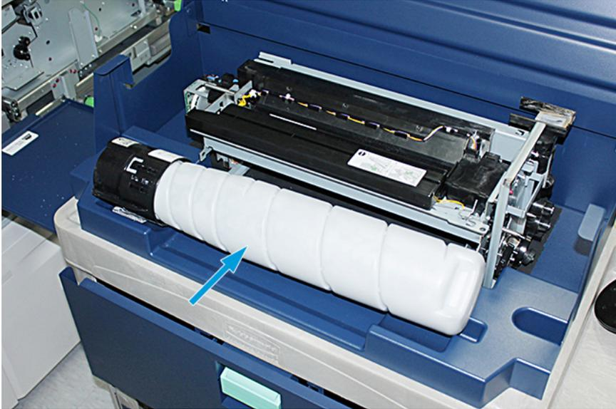
28. Afloje el tornillo en el conjunto del eje y quite los dos tornillos del bastidor que sirven para fijar el conjunto del suministrador. Coloque los tornillos en la caja de herramientas en el carro de almacenamiento.
