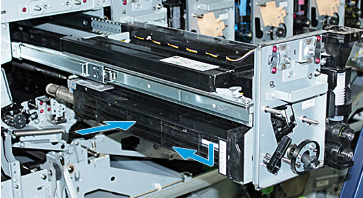
17. Enganche la palanca de retención del cartucho de cilindro en sentido antihorario y suelte la guía delantera del cilindro en sentido horario.
