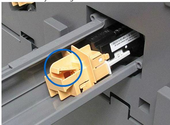
3. Retire la guía y el corotrón de carga del módulo xerográfico.
