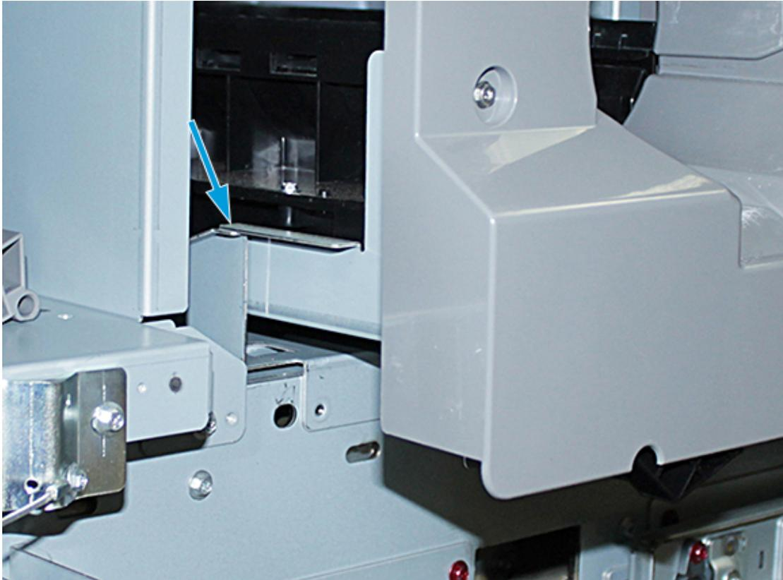
8. Levante la parte frontal del conjunto distribuidor y deslícelo al interior de la prensa hasta el enganche negro.
