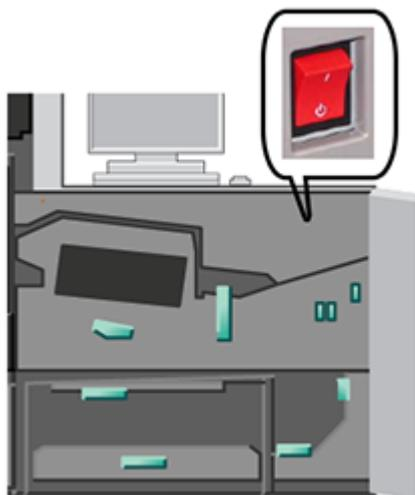
⚠ Importante: Esta acción corta de inmediato la corriente eléctrica de todos los componentes de la prensa de producción. Utilice este método en lugar del proceso de apagado más lento que se realiza con el interruptor de alimentación situado a la derecha de la prensa.
