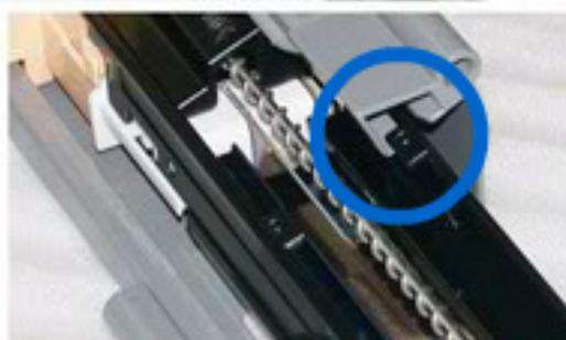
6. Coloque a la guía del corotrón en los pasadores del módulo xerográfico.
