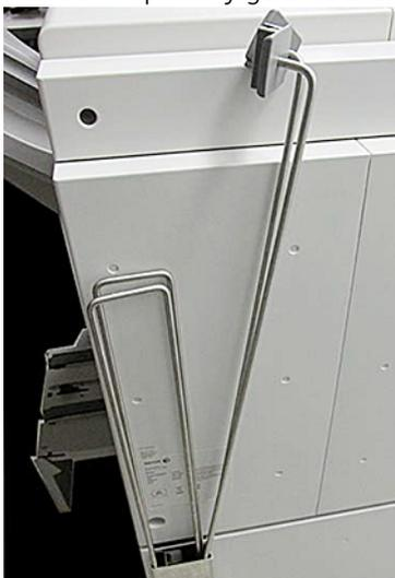
2. En la bandeja de detrás de los enganches del soporte de alambre, en los cuatro orificios, introduzca los dos soportes de alambre.
