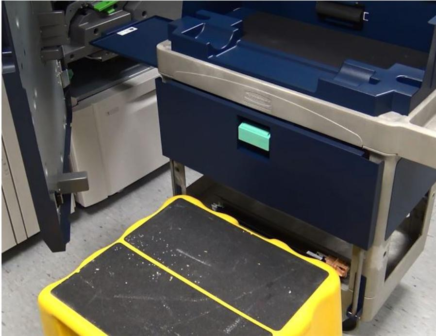
23. Mientras presiona el enganche del riel, levante la parte delantera del conjunto y deslícela hacia delante.
