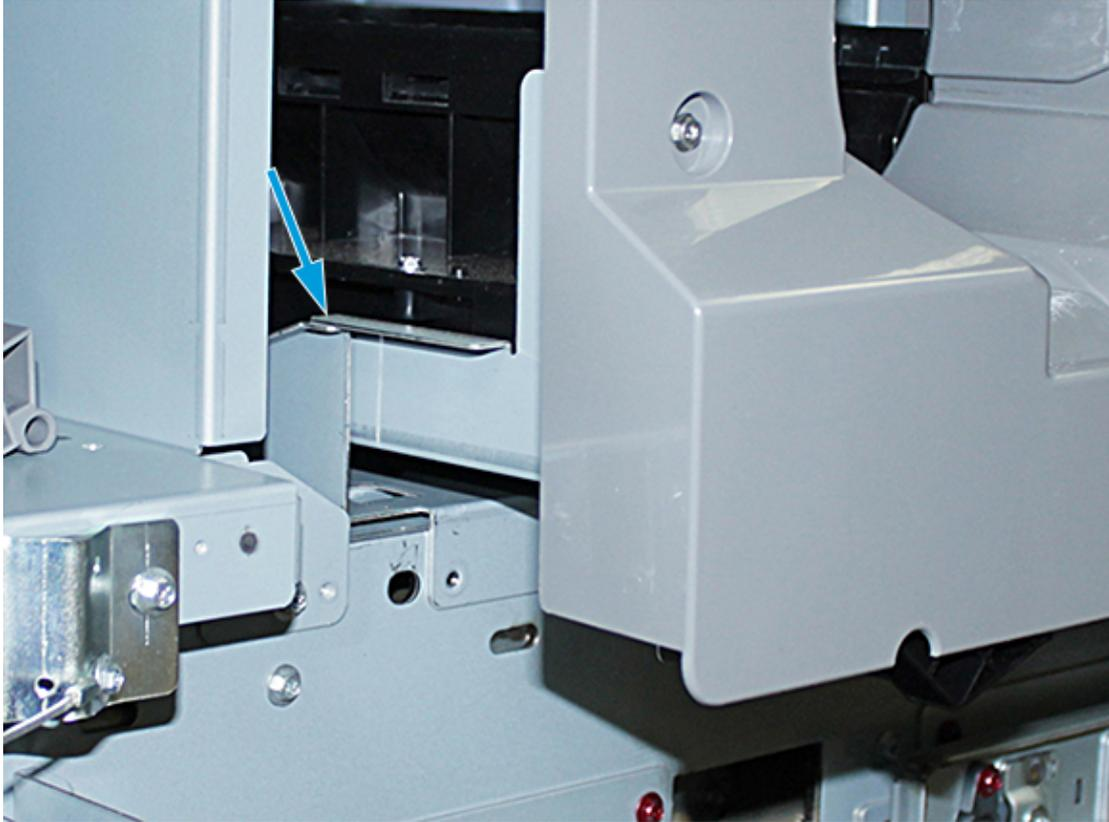
8. Soulevez l'avant du module de distribution et faites-le glisser dans la presse, jusqu'au levier noir.
