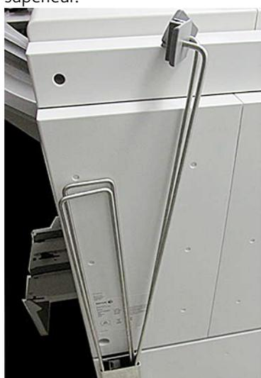
2. Sur le bac derrière les plaques métalliques, insérez les deux supports métalliques dans les quatre trous.
