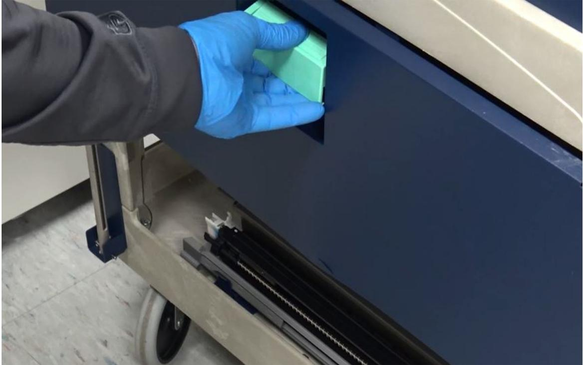
7. Récupérer le module de distribution de la Station 1 ou 6 sur le chariot et le positionner sur le bâti.
