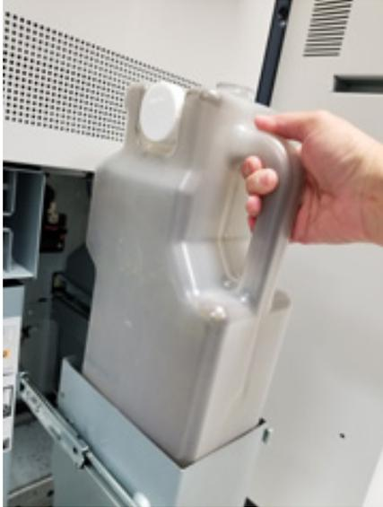
4. Retirer le bouchon du support sur le côté de la bouteille. Appuyer fermement sur le bouchon, une fois qu'il est placé sur le trou de la bouteille pleine.
