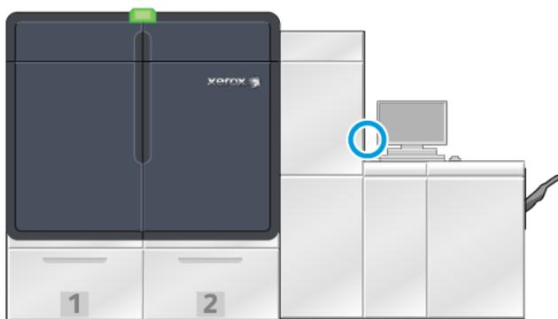
6. Tous les modules du système commencent à s'initialiser et le module four entre en cycle de préchauffage. La presse de production effectue une vérification du système. Celle-ci peut durer quelques minutes. Vous pouvez mettre à profit ce temps pour programmer la presse de production pour un travail. Lorsque la presse est prête, le processus d'impression démarre automatiquement.
