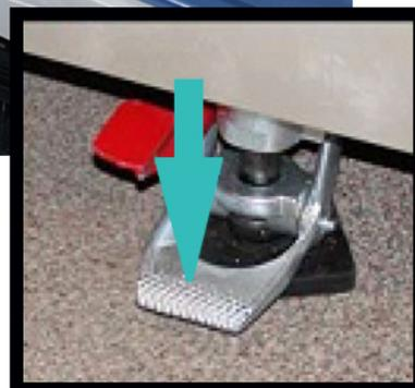
**!** **Attention :** À l'étape qui suit, lorsque le levier de la porte inférieure est déverrouillé, la porte s'ouvre soudainement. Tenir la poignée de la porte et remettre la porte en place en la faisant glisser.
