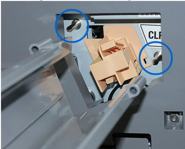
2. Appuyez sur la languette de dégagement à l'avant du corotron de charge et tirez jusqu'à ce que le corotron de charge s'enclenche sur le guide.
