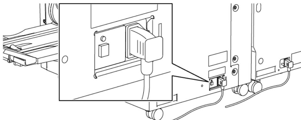
L'interruttore automatico si trova nella parte posteriore del dispositivo. L'interruttore è generalmente abilitato (in posizione **ON**).
