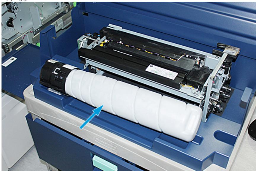
28. Allentare la vite sul complessivo coclea e rimuovere le due viti sul telaio che tiene fissato il complessivo erogatore. Mettere le viti nel comparto degli attrezzi sul carrello.
