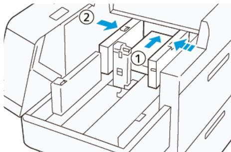
5. Caricare i fogli restanti nel vassoio, quindi allineare i bordi della carta nella direzione mostrata (1). Muovere la guida terminale in modo che tocchi leggermente i bordi della carta (2). Regolare le guide della carta premendo la leva di rilascio della guida e spostando lentamente le guide finché non toccano leggermente i bordi della carta.
