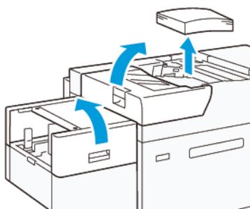
3. Fissare il vassoio di estensione XLS e la piastra di estensione.
