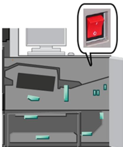
Importante: L'azione interrompe immediatamente il passaggio di elettricità ai componenti della stampante e va scelta anziché eseguire la procedura di arresto più lenta avviata dal pulsante di alimentazione sul lato destro della stampante.
