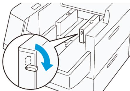
3. Se la guida terminale è riposta, aprire l'otturatore della guida terminale, quindi ruotare la guida terminale per bloccarla in posizione verticale.
