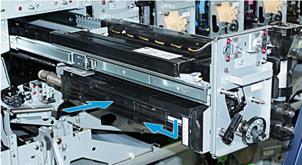
17. Innestare (senso antiorario) il fermo della cartuccia fotoricettore e rilasciare (senso orario) la guida anteriore fotoricettore.
