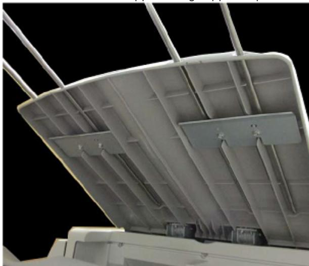
3. Attaccare le protezioni di plastica delle guide metalliche sulle aste di supporto.
