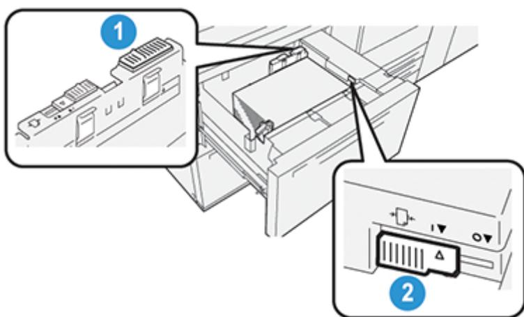
1. Leva di regolazione dell'alimentazione posteriore
