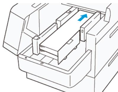
7. Posizionare la guida terminale XLS posteriore in modo da adattarla alla carta caricata. La guida terminale posteriore è rimovibile. Installare la guida terminale nella direzione che assicura che la superficie metallica tocchi la carta.
