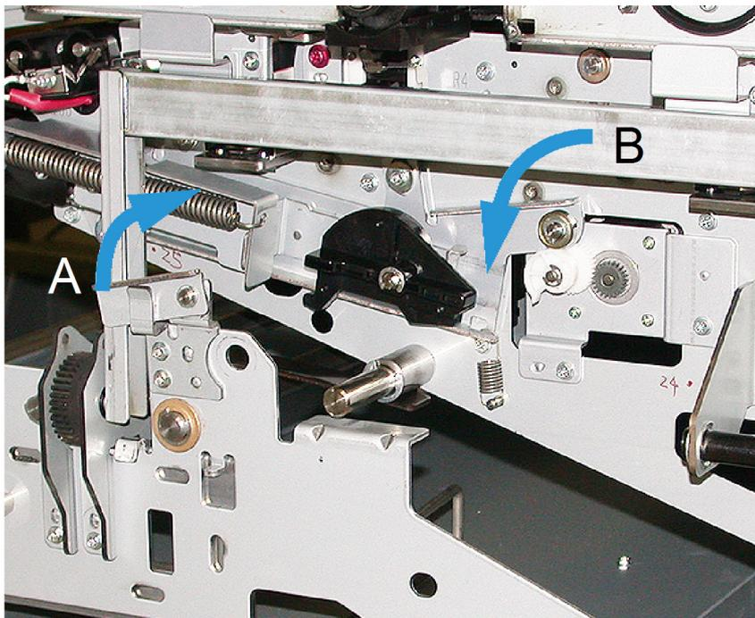
6. Prima di eseguire questo passaggio, utilizzare la copertura nera di protezione contro la luce. Se si sostituisce il toner nella stazione 6, svitare le due viti del volano e quindi rimuovere il volano.
