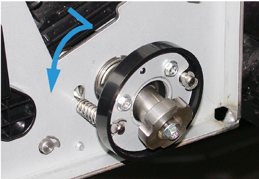
16. Spostare il modulo xerografico nella posizione di servizio. Ruotare in senso orario il fermo della cartuccia fotoricettore e tirarlo verso la parte anteriore della stampante.
