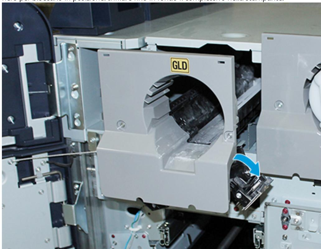
10. Prelevare le viti dal comparto degli attrezzi e fissare il complessivo coclea con tre viti.
