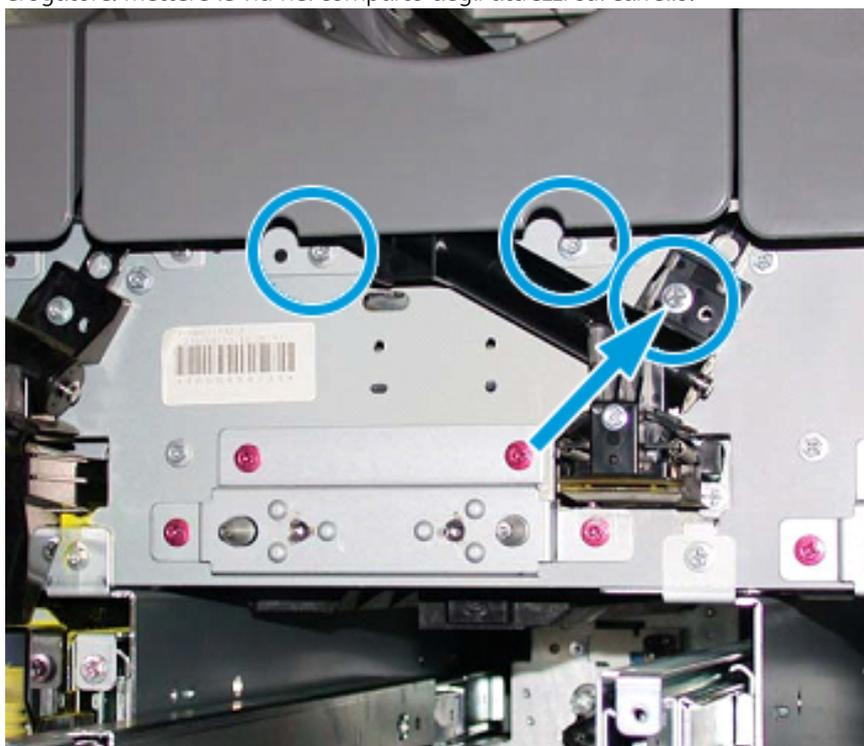
**!** **Attenzione:** nel passaggio successivo, lo sportello inferiore si abbassa improvvisamente quando si rilascia il fermo. Tenendolo per la maniglia, abbassare lo sportello lentamente.
