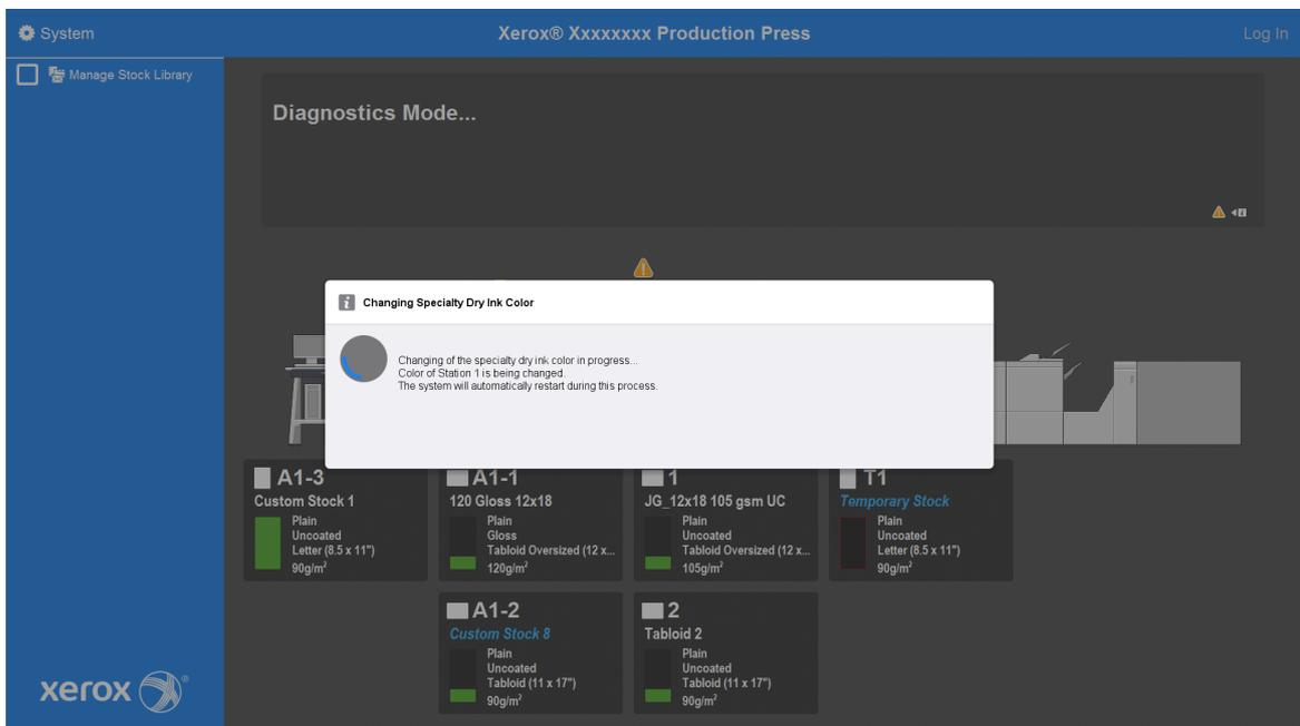
31. Una volta completato il riavvio del sistema, la stampante viene riavviata e l'icona del nuovo toner speciale viene visualizzata nel Control Center della stampante.
