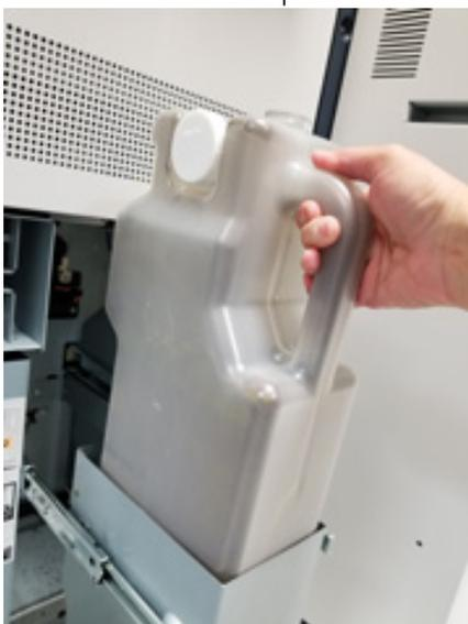
4. Rimuovere il tappo situato sul lato del contenitore. Usare il tappo per chiudere saldamente l'apertura in cima al contenitore.
