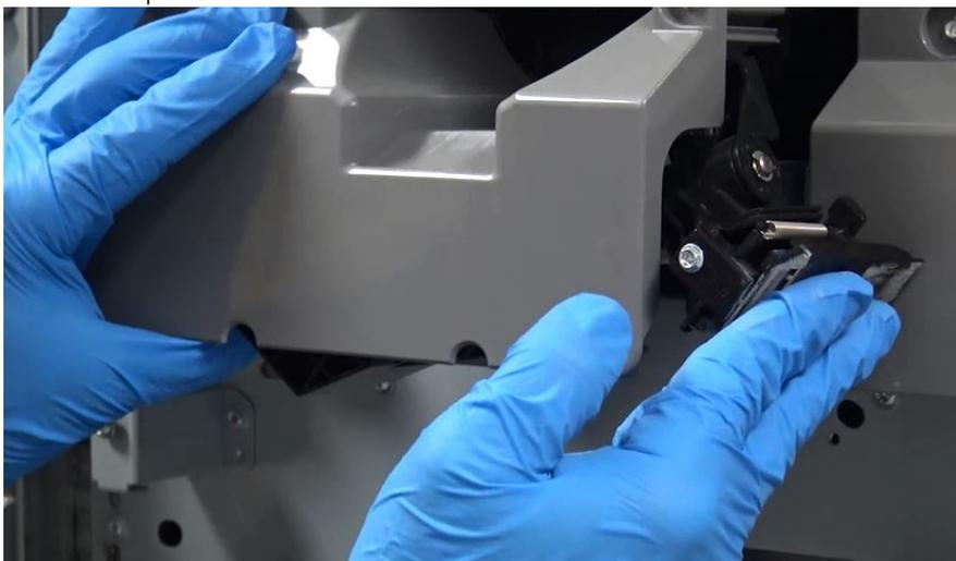
31. Usando entrambe le mani estrarre il complessivo erogatore e appoggiarlo sul carrello di servizio.
