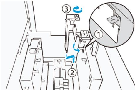
6. Inserire la guida A nella fessura presente all'interno (1) e sul fondo (2) del vassoio. Serrare la vite per fissare la guida (3).
