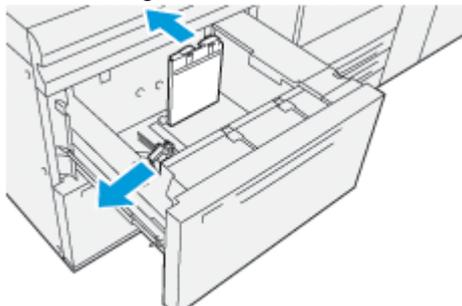
6. Caricare la carta allineando il bordo della pila all'angolo anteriore destro del vassoio.
