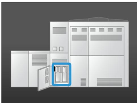
Quando uno dei contenitori è pieno, nel Control Center viene visualizzato un messaggio che avverte di sostituire il contenitore. Finché il secondo contenitore di scarto non è pieno, la stampante continua a funzionare. Questo consente di sostituire il contenitore pieno con uno vuoto senza che la macchina interrompa la stampa.
