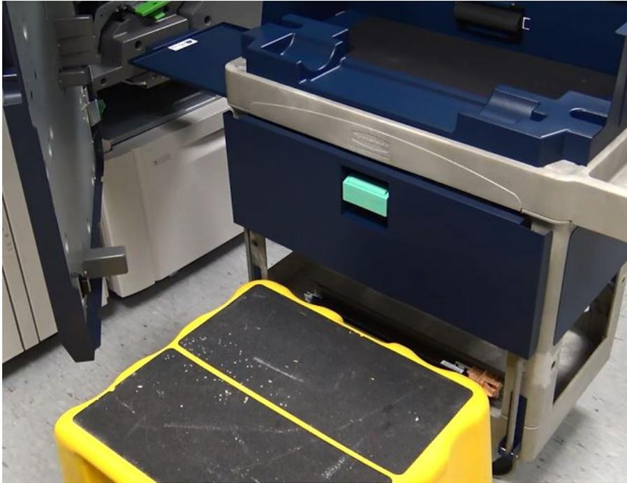
23. Spingere sul fermo del binario, sollevare la parte anteriore del complesso e farlo scivolare in avanti.
