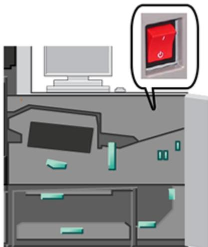
Importante: Esta ação corta a eletricidade imediatamente para todos os componentes da Impressora de Produção. Use esse método em vez do processo de desligamento mais lento do Interruptor de alimentação no lado direito da impressora.
