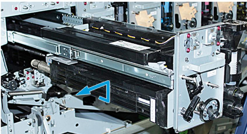
20. Coloque imediatamente o fotorreceptor no saco protetor preto. Para evitar danos ao Cartucho do fotorreceptor, coloque o lado plano do cartucho voltado para baixo no carrinho de armazenamento.
