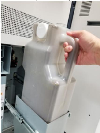
4. Remova a tampa do retedor na lateral do recipiente cheio. Pressione a tampa firmemente no orifício aberto na parte superior do recipiente cheio.
