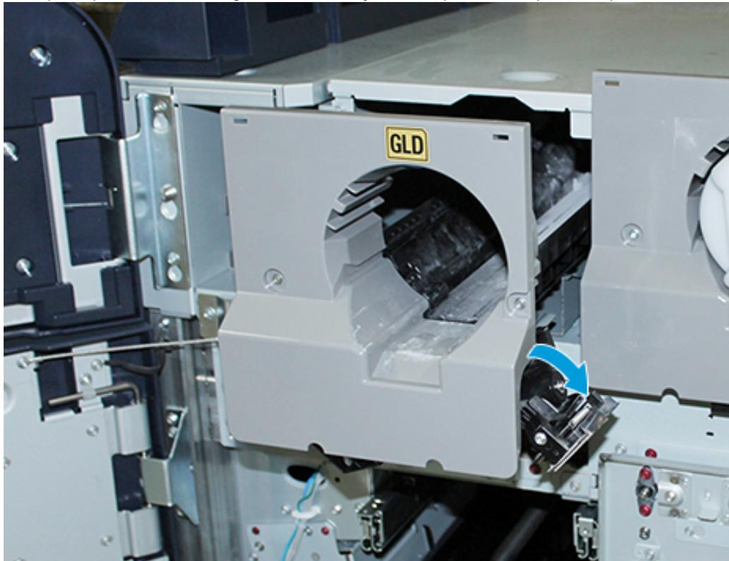
10. Acesse os parafusos no escaninho do carrinho e prenda o Conjunto do eixo helicoidal com os três parafusos.
