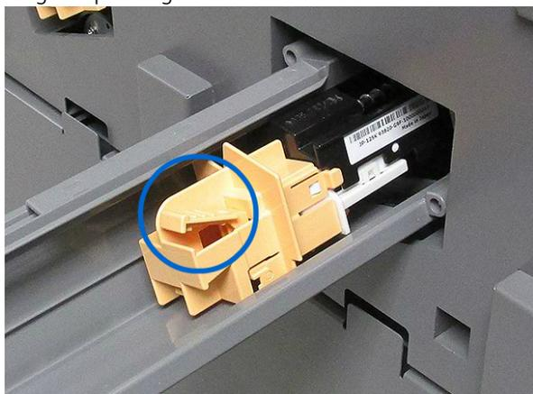
3. Remova a guia e o corotron de carga do módulo Xerográfico.
