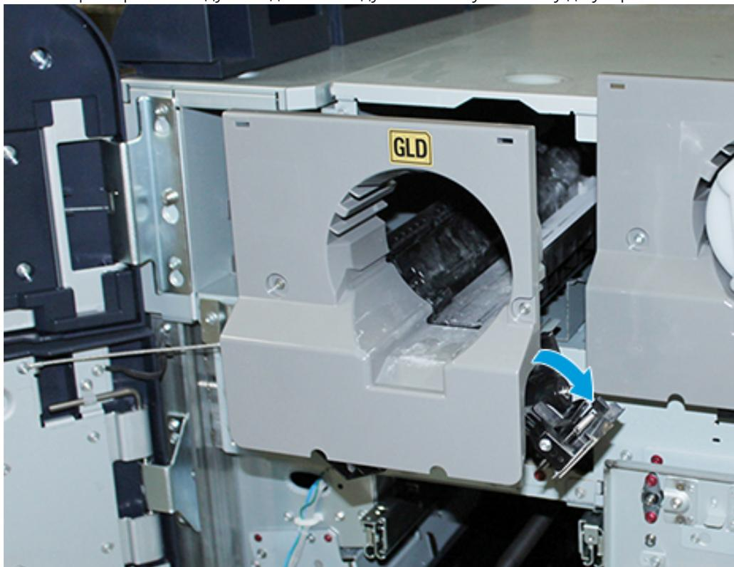
10. Возьмите винты, сложенные в лотке тележки и закрепите узел шнека тремя винтами.
