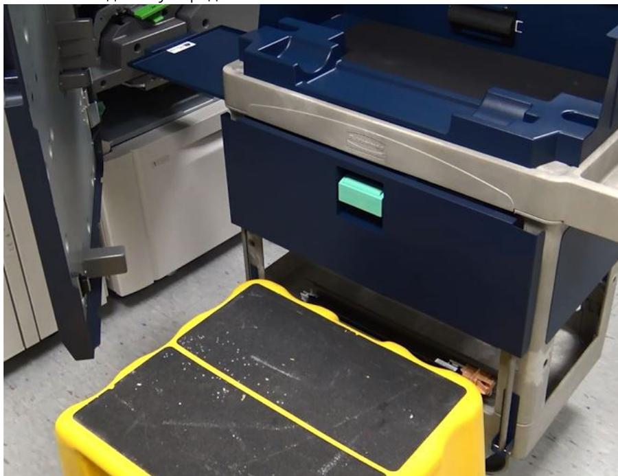
23. Прижав фиксатор направляющей, приподнимите узел и сдвиньте его вперед.
