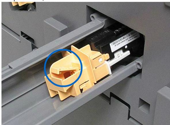
3. Снимите направляющую и коротрон заряда с ксерографического модуля.
