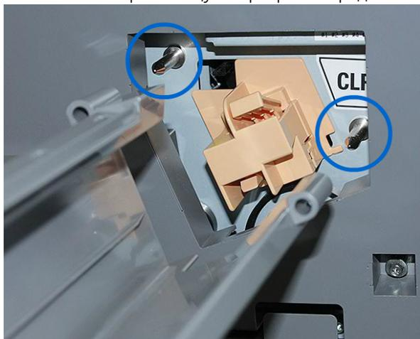
2. Прижав язычок спереди коротрона заряда, выдвиньте коротрон, чтобы он зафиксировался на направляющей.
