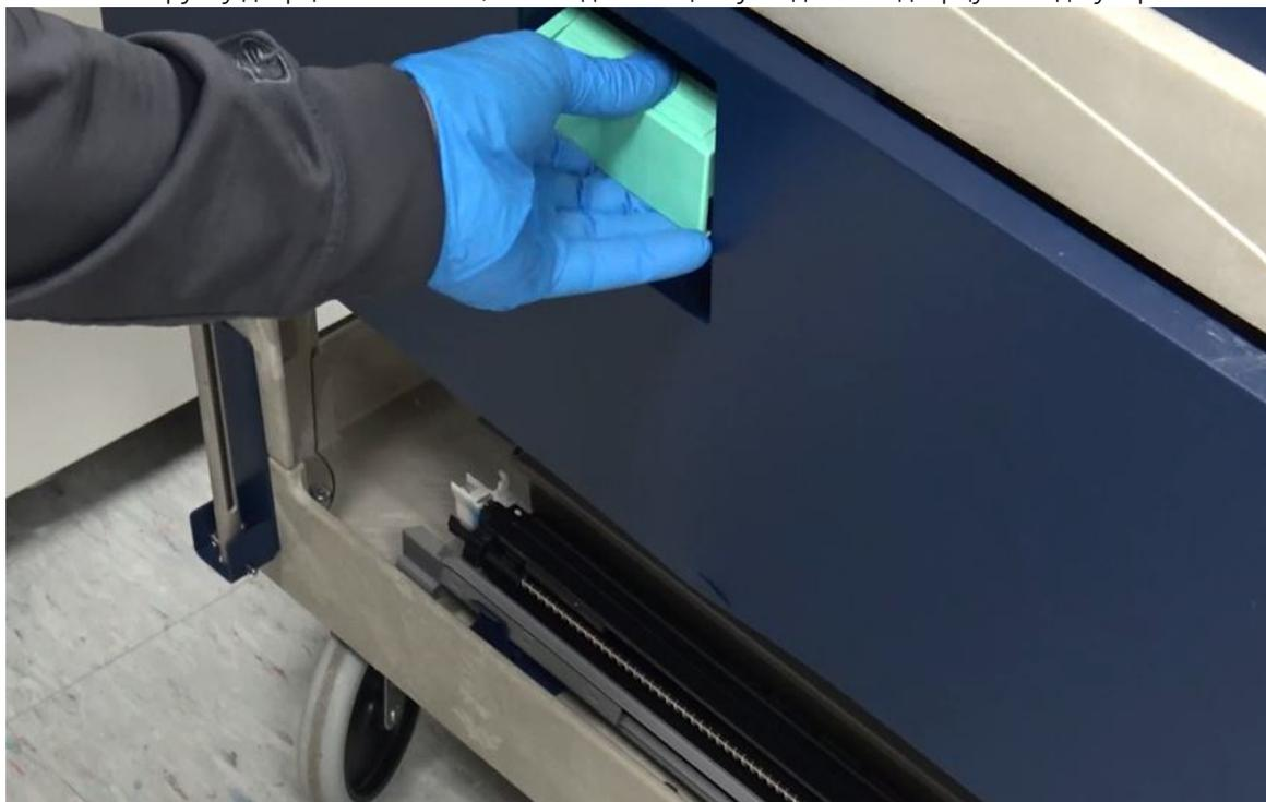
7. Возьмите с тележки модуль дозатора станции 1 или 6 и поставьте его на раму.
