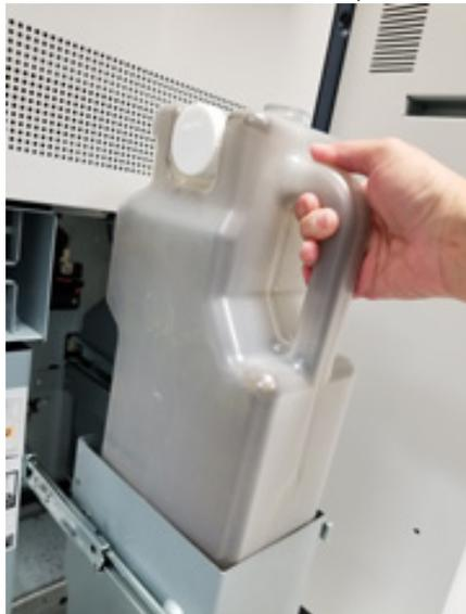
4. Извлеките колпачок из держателя на стороне заполненного сборника. Плотно установите колпачок в отверстие на верхней части заполненного сборника.
