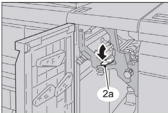
4. Die vordere Abdeckung des Schnittstellenmoduls schließen.
