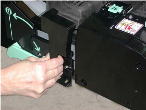
5. Nur den orangefarbenen Griff anfassen und die Fixieranlage aus dem Transfermodul heben.
