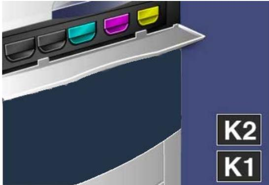
2. Vor dem Herausnehmen des Moduls Papier auf den Fußboden legen für den Fall, dass überschüssiger Toner aus dem Modul fällt.
