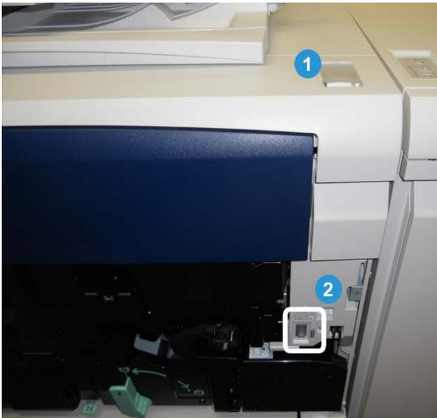
Das Gerät verfügt über zwei Netzschalter:
