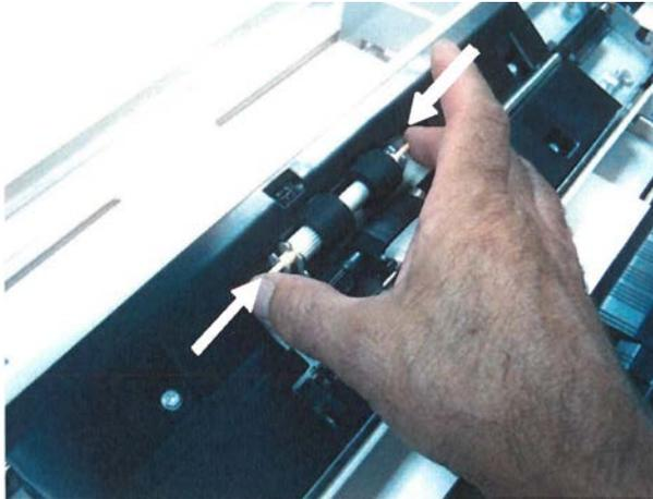
4. Zum Austauschen der Schieberolle die Metallachse zusammendrücken.
