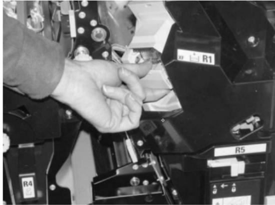
4. Falls erforderlich, das Heftklammermagazin öffnen und die gestaute(n) Heftklammer(n) entfernen.
