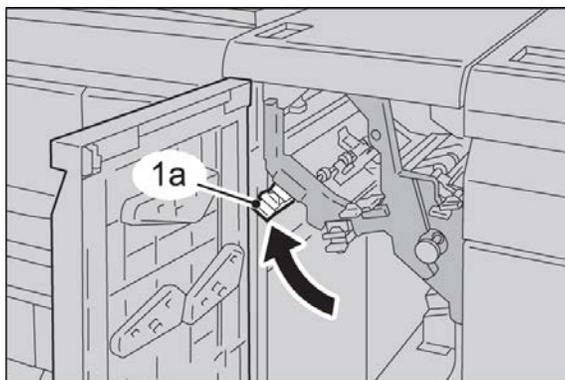
4. Chiudere la copertura anteriore del modulo di interfaccia.
