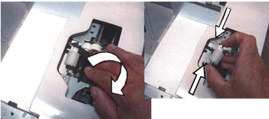
3. Sostituire il rullo di alimentazione adottando la stessa tecnica.
