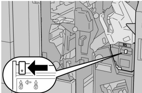
4. Tenere R5 come mostrato in figura e rimuovere il contenitore punti di scarto dalla macchina.
