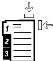
5. Regolare le guide della carta premendo verso l'interno i dispositivi di rilascio e muovendo con cautela la guida del bordo fino a quando non tocca il bordo del materiale presente nel vassoio.
