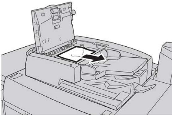
4. Se vengono visualizzate delle istruzioni che richiedono di aprire la copertura interna, sollevare la leva e aprire la copertura interna. Rimuovere l'originale inceppato.
