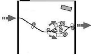
Quando i supporti entrano nel modulo di interfaccia, vengono inviati al dispositivo antiarricciatura del modulo di interfaccia per la correzione dell'arricciatura della carta. Il dispositivo antiarricciatura del modulo di interfaccia è dotato di rulli superiori e inferiori che applicano una pressione al supporto in base ai seguenti criteri:
