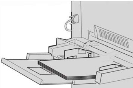
Il vassoio bypass è un vassoio carta situato sul lato sinistro della macchina. Quando non è in uso, il vassoio può essere piegato. Quando è in uso e abbassato, il vassoio può essere allungato per contenere i supporti più lunghi.
