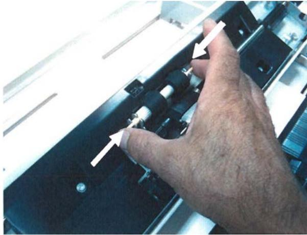
4. Sostituire il rullo d'impulso adottando la stessa tecnica.
