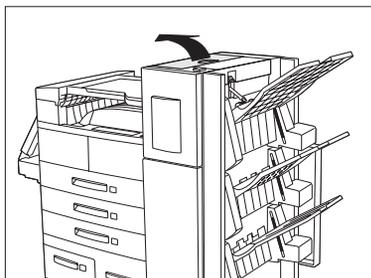
Seguire la procedura riportata di seguito quando sul display del pannello di controllo viene visualizzato il messaggio: **Inceppamento carta. Pulire area G.**
