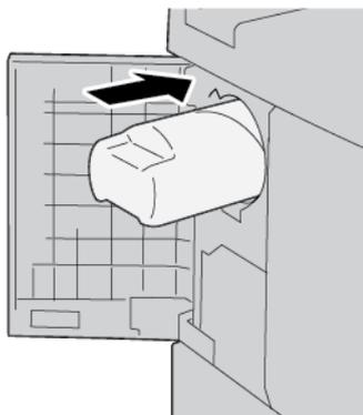
10. Refermer le capot du toner. S'il ne se ferme pas complètement, vérifier que la cartouche est en position verrouillée et qu'elle est insérée dans l'orientation appropriée.
