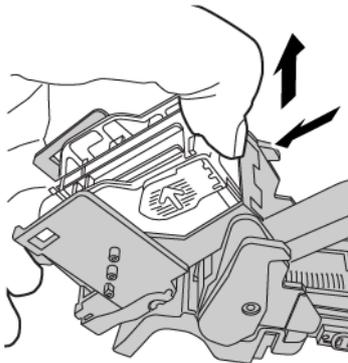
5. Pour installer la cassette de recharge d'agrafes dans la cartouche, rentrer la languette à son extrémité dans le petit trou de la cartouche. Appuyer fermement sur la cassette d'agrafes dans la cartouche jusqu'à enclenchement.
