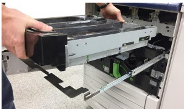
3. Die Entwicklerladeneinheit mithilfe der eingebauten Schienen im Wagen auf demselben Regal platzieren, auf dem die entsprechende Tonerausgabereinheit platziert wurde.
