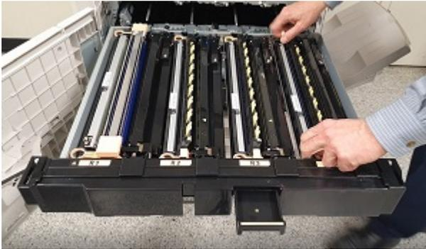
5. Die Trommeleinheiten abdecken und an einem sauberen, dunklen Ort lagern. Die Trommeleinheiten werden später wieder eingebaut.
