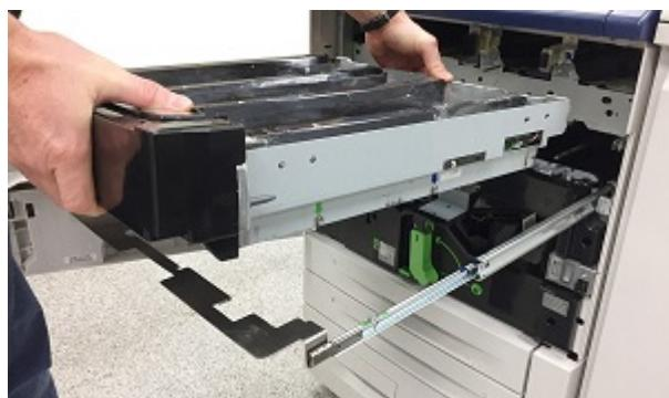
3. Ladicu razvijača stavite u košaricu pomoću ugrađenih vodilica na istu policu na koju ste stavili odgovarajući sklop dozatora tonera.
