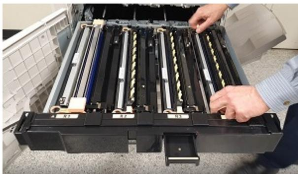
5. Dekk trommelkassetten og oppbevar dem på et rent, mørkt sted. Trommelkassetten installeres på nytt senere i prosedyren.
