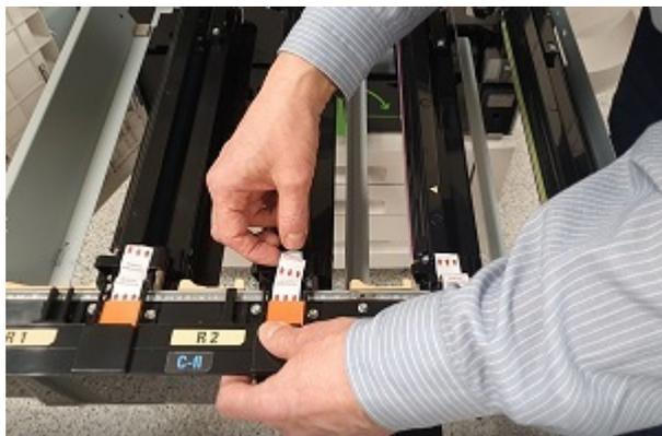
3. Trommelkassetten har merker som indikerer fremre og bakre del av kassetten. Juster frontenden av trommelkassetten med fronten av fremkallerskuffen, og plasser kassetten i skuffen.
