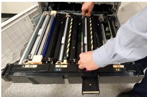
**!** **Forsiktig:** Ikke rør eller skrap på overflaten til trommelkassetten.
