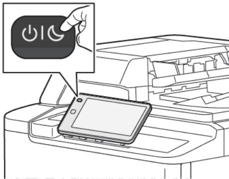
2. Glavni prekidač za uključenje i isključenje upravlja glavnim napajanjem pisača. Za normalan rad pisača uključite glavno napajanje. Prije povezivanja kabela očistite pisač ili, ako ga je potrebno ponovno pokrenuti, pritisnite glavni prekidač za uključenje i isključenje te ga postavite u položaj Isključeno.
