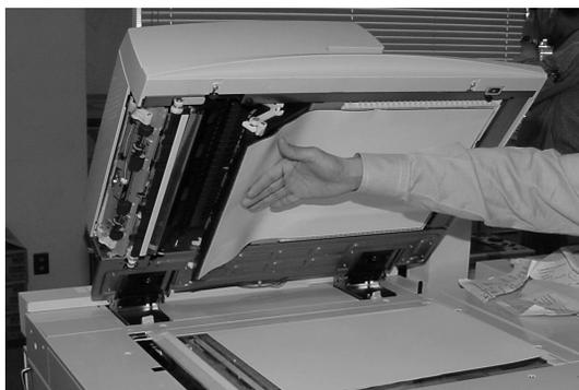
5. Nettoyer la glace réfléchissante, la bande métallique, les deux côtés de la bande plastique blanche et les rouleaux avec un chiffon doux légèrement humide afin d'éliminer toute trace de saleté, puis les essuyer avec un chiffon doux et sec.
