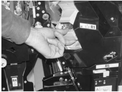
3. Heftklammermagazin gerade aus dem Gerät herausziehen.
