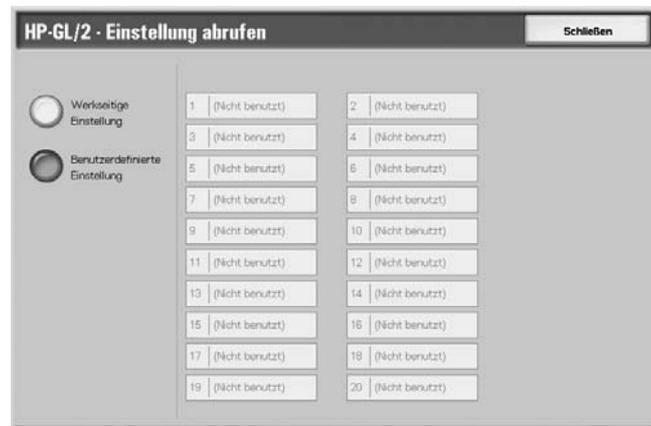
2. Sollen die Standardeinstellungen der Software verwendet werden, **Werkseitige Einstellung** antippen, zum Auswählen gespeicherter benutzerdefinierter Einstellungen **Benutzerdefinierte Einstellung** wählen.
