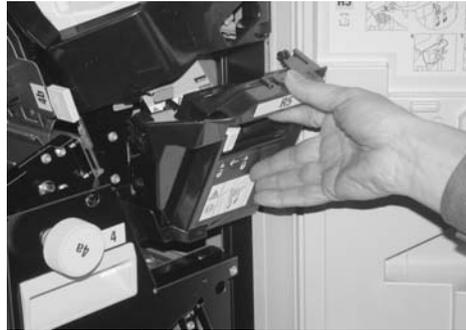
5. Behälter in das Gerät einsetzen und einrasten lassen. Nach kurzer Zeit wird der neue Heftabfallbehälter automatisch verriegelt.
