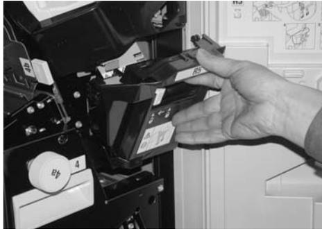
5. Inserte el contenedor en la máquina hasta que oiga un chasquido. Después de un instante, el nuevo contenedor de restos de grapas se bloqueará automáticamente.
