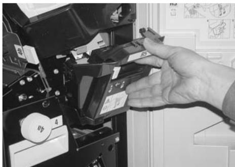
5. Inserire il contenitore nella macchina finché non si sente uno scatto. Dopo un breve periodo di tempo, il nuovo contenitore degli scarti di pinzatura si blocca automaticamente.
