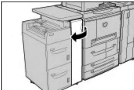
2. Griff 1a nach rechts schwenken und Knopf 1c nach rechts drehen. Gestautes Druckmaterial entfernen.
