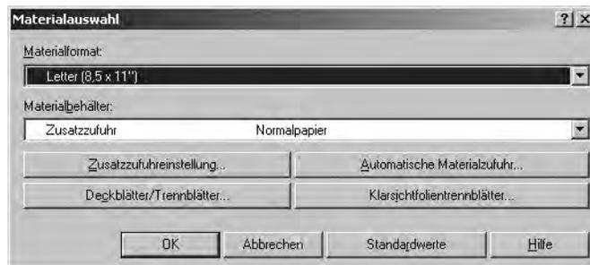
8. Wenn Behälter 3 oder 4 für das Registermaterial verwendet wird, auf die Schaltfläche **Automatische Materialzufuhr** klicken und „Registermaterial“ als Materialart auswählen.
