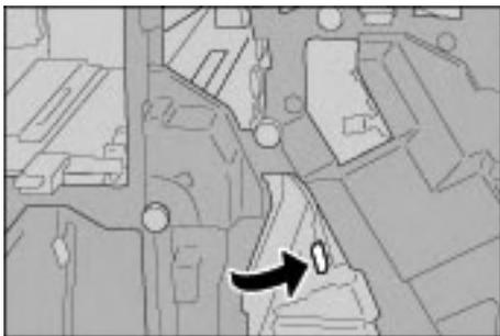
4. Die rechte Finishertür schließen. Wird diese Tür nicht richtig geschlossen, ist kein Gerätebetrieb möglich.
