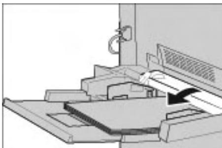
2. Gestautes Material sowie sämtliches Material aus der Zusatzzufuhr entfernen.
