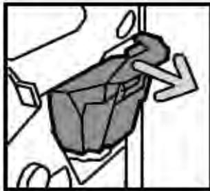
5. Den neuen Behälter auspacken. Zum Entsorgen des vollen Behälters die Verpackung des neuen Moduls verwenden.
