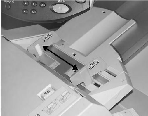
2. Materialstapel an der Behältervorderseite ausrichten. Vordrucktes Material so einlegen, dass die bedruckte Seite nach oben und der Registerreiter zum Einzug weist.
