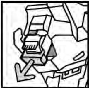
3. Die seitlichen Positionsmarkierungen am Magazin drücken und den Heftklammerbehälter aus dem Magazin nehmen.
