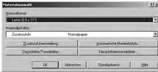
8. Bei Verwendung von Behälter 3 oder 4 auf **Automatische Materialzufuhr** klicken und anschließend eine geeignete Materialart auswählen.
