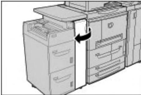
2. Mithilfe des Freigabehebels die linke untere Abdeckung öffnen.
