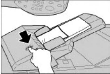
2. Abdeckung 1e öffnen und das gestaute sowie sämtliches eingelegte Druckmaterial vollständig entfernen.
