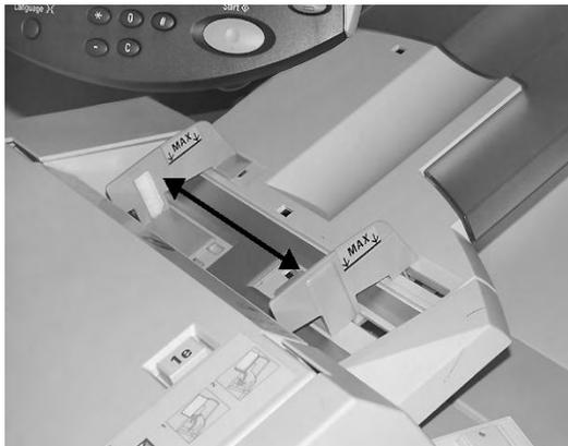
2. Vorgedrucktes Material so einlegen, dass die bedruckte Seite nach oben und der Registerreiter zum Einzug weist.
