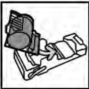
5. Das Heftklammermagazin wieder einsetzen und bis zum hörbaren Einrasten in das Gerät schieben.
