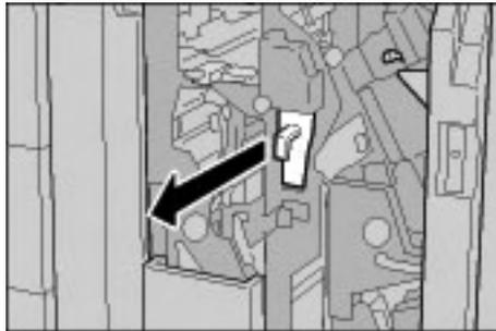
3. Sämtlichen Locherabfall in einem geeigneten Behälter leeren.
