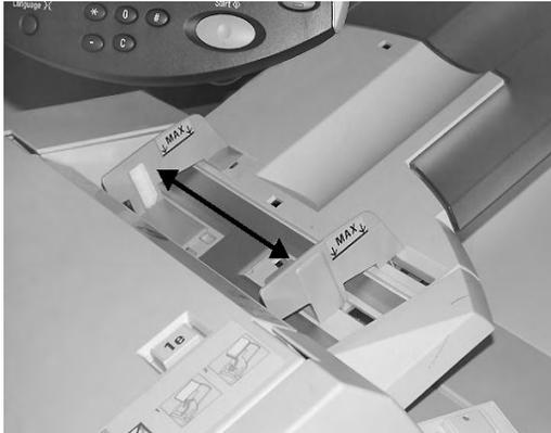
2. Coloque el papel alineándolo con la parte delantera de la bandeja. Si el papel ya está impreso, coloque el papel con la cara impresa hacia arriba y con el lado de la lengüeta para que se alimente primero.
