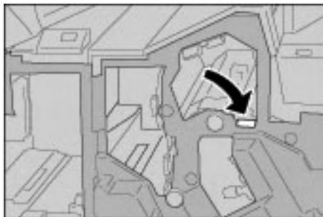
4. Cierre la cubierta derecha completamente. La máquina no funcionará si la cubierta está ligeramente abierta.
