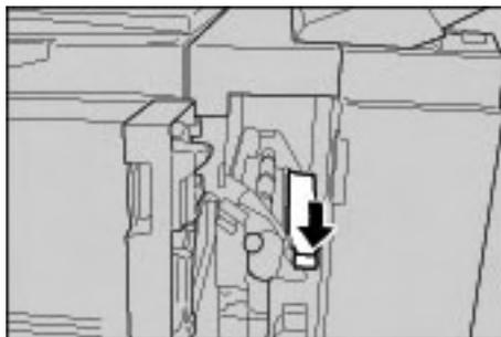
4. Cierre la cubierta izquierda de la acabadora completamente. La máquina no funcionará si la cubierta está ligeramente abierta.
