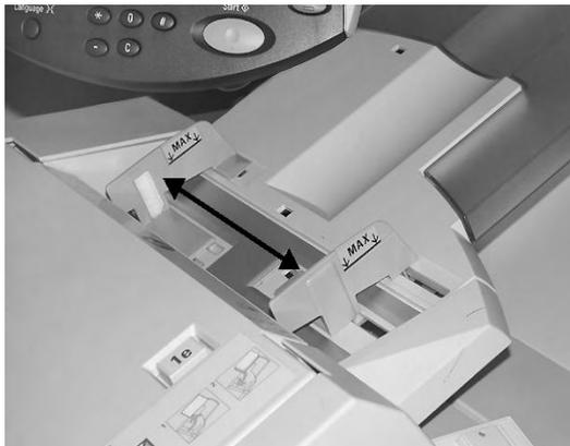
2. Se o papel for pré-impresso, coloque-o com a face impressa para cima e o lado da aba para ser alimentado primeiro.
