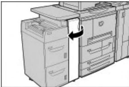
2. Abra a tampa inferior esquerda segurando a alavanca de liberação.
