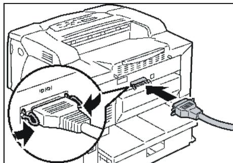
2. Параллельді шоғырсым қосқышының айырын басып шығарғыштың интерфейстік қосқышына қондырыңыз.
