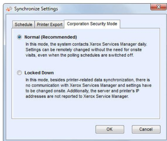
Установите переключатель в положение **Locked Down** (Блокировано).
