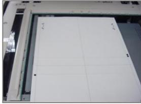
2. Abra la cubierta del Alimentador de documentos de documentos (ADF). Observe que el Panel de control muestre la pantalla Ajuste de alineación automática. Las instrucciones de esta pantalla lo guiarán para realizar los pasos siguientes. Observe que en la parte inferior derecha de la pantalla aparezca lo siguiente: Escanear página(s): 0.
