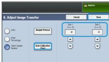
37. Ya puede imprimir una muestra para ver los resultados del ajuste o puede guardar inmediatamente los resultados.
