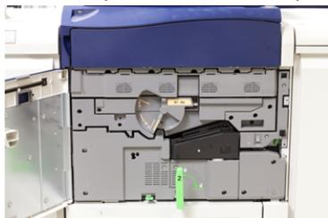
3. Faire pivoter la **poignée du tiroir de module photorécepteur** en position de déverrouillage.
