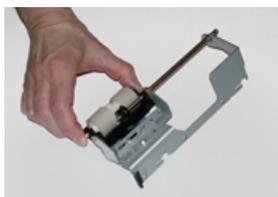
10. Reinstallare il gruppo rullo di ritardo nel vassoio. Allineare i fori del gruppo al telaio del vassoio in modo da far combaciare i fori. Reinstallare il gruppo rullo di ritardo nel vassoio. Spingere il gruppo completamente a destra usando il perno come guida. Verificare che il dispositivo sia completamente inserito nei fori e che le aree con le 3 viti siano allineate.
