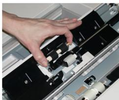
4. Rimuovere e sostituire il rullo di impulso usando la stessa tecnica.
