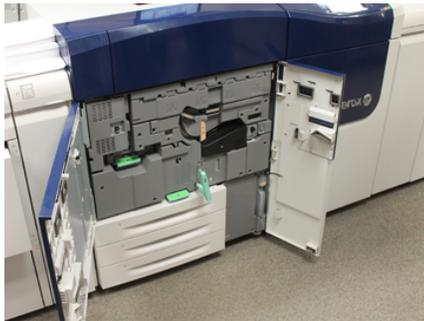
3. Libere y extraiga el módulo de transferencia girando la manija verde **2** (en el centro) hacia la derecha hasta que quede en posición horizontal. Tire del módulo hacia afuera en forma recta hasta que se detenga.
