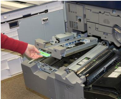
5. Si el papel está atascado en la parte superior del módulo de transferencia, quite el papel del rodillo de registro (área **2a**) tirando hacia afuera en forma recta.
