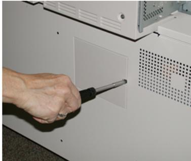
3. Extraiga y separe la cubierta del filtro de succión.
