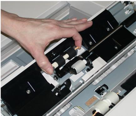
4. Extraiga y sustituya el rodillo empujador con la misma técnica.
