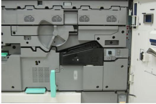
4. Extraiga la cubierta del fusor usando un destornillador T10 Torx para quitar el único tornillo de montaje ubicado en el centro de la cubierta.
