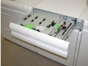
6. Levante las palancas **2a** y **2b**, y retire el papel atascado.
