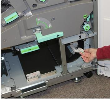
6. Ya es seguro desbloquear el cajón del módulo de salida y extraerlo. Tome la manija verde (**4**) del cajón y gírela hacia la derecha hasta que quede en posición horizontal. Tire lentamente del conjunto del cajón hacia afuera, hasta que se detenga.
