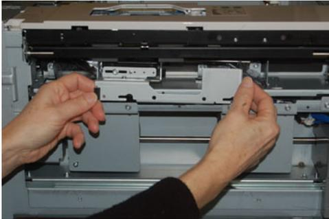
7. Con el conjunto del rodillo de retardo afuera, acceda al rodillo de alimentación y retírelo. Para hacerlo, oprima los dos extremos del eje metálico, levántelo y extráigalo. Para colocar el nuevo, oprima los dos extremos del eje del nuevo rodillo, inserte los extremos del rodillo en las muescas y suéltelos.
