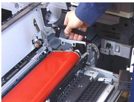
12. Sobre el lado derecho del módulo, empuje ligeramente el módulo y levante la correa del fusor en forma recta hacia afuera de la prensa, sosteniendo el peso del módulo con las manos.
