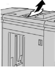
2. Abra la cubierta delantera del HCS.
