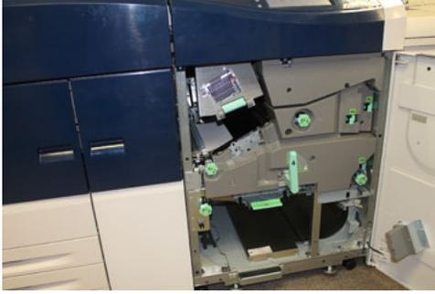
3. Para despejar el área del bafle de entrada (**3a** y **3b**), levante la palanca del módulo de enfriamiento superior **3a** y también gire el mando **3b** en sentido horario para que el papel atascado avance por el rodillo de entrada del módulo. Asegúrese de que el papel haya pasado por todo el rodillo más allá del área de entrada.
