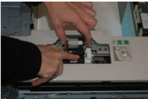
4. Coloque el nuevo rodillo oprimiendo los dos extremos del eje metálico y presionando hacia abajo la brida negra, inserte los extremos del rodillo en las muescas y suéltelos.
