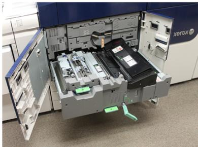
4. Cuando se haya enfriado el fusor, extraiga el módulo de transferencia hasta la posición de despeje de atascos.
