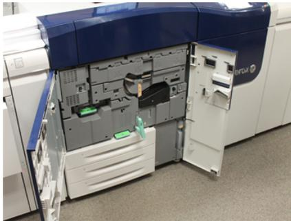
3. Gire la manija **R1-R4** del cajón del módulo de cilindro hasta que quede abierto.
