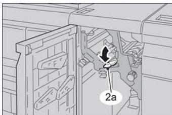
4. Cierre la cubierta delantera del módulo.
