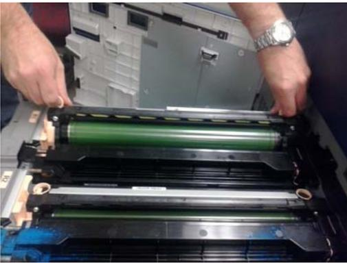
**9.** Pulse en forma simultánea ambos extremos del cartucho de cilindro para instalar **horizontalmente** el cartucho de cilindro.
