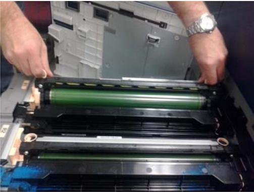
9. **Simultanément**, appuyer **horizontalement** sur les deux extrémités de la cartouche du tambour pour le placer en position.
