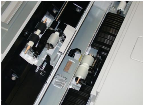
3. Rimuovere e sostituire il rullo di alimentazione premendo i lati dell'albero metallico e sollevandolo.
