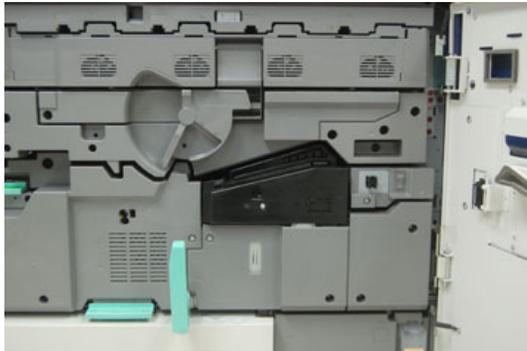
4. Rimuovere il coperchio del fusore usando un cacciavite Torx T10 per svitare l'unica vite al centro del coperchio.
