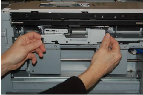
7. Con il blocco del rullo di ritardo estratto, accedere e rimuovere il rullo di alimentazione. Per rimuoverlo, premere entrambe le estremità dell'albero metallico e sollevarlo. Per sostituirlo, premere entrambe le estremità del nuovo albero del rullo, inserirlo e rilasciare le estremità negli incastri.
