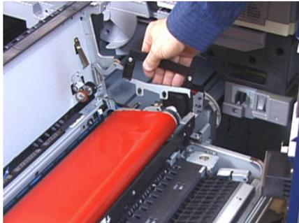
12. Stando davanti al lato destro del cassetto, allontanare il modulo spingendolo leggermente e sollevare la cinghia del fusore verso l'alto e verso l'esterno della stampante, lasciando che il peso del modulo gravi tutto sulle mani.
