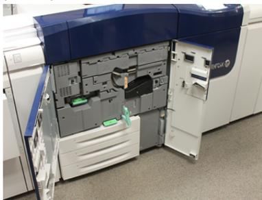
3. Individuare la maniglia verde (2) e ruotare in senso orario in posizione orizzontale per sbloccare il cassetto di trasferimento.
