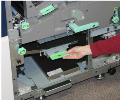
5. Nella parte più a destra della stampante, individuare la leva **5a** e la manopola **5b**. Abbassare la leva **5a** per accedere all'area dell'invertitore e rimuovere la carta. Ruotare la manopola **5b** in senso orario per far avanzare la carta diretta all'invertitore.
