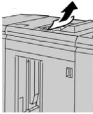
2. Aprire la copertura anteriore dell'impilatore ad alta capacità.
