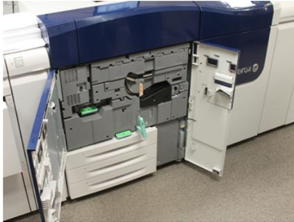
3. Ruotare e girare la maniglia R1-R4 del cassetto delle cartucce fotoricettore in posizione di sblocco.
