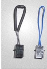
7. Collegare il ponticello corretto al connettore bianco esposto nella parte frontale del gruppo fusore premendo insieme le due estremità. Il collegamento non ha meccanismi di sgancio. Per scollegare è sufficiente tirare.
