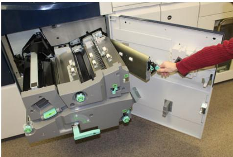
9. Impugnare la maniglia verde (4) del cassetto e riposizionare completamente con delicatezza il blocco del cassetto di uscita. Ruotare la manopola verso sinistra per bloccare il cassetto.
