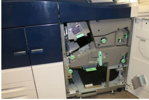
3. Per ripulire l'area del deflettore di ingresso (**3a** e **3b**), alzare la leva **3a** del raffreddamento superiore e ruotare la manopola **3b** in senso orario per far avanzare la carta inceppata nel modulo del rullo di ingresso. Verificare che la carta sia completamente uscita dal rullo oltre l'area di ingresso.
