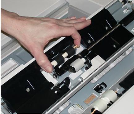
4. Rimuovere e sostituire il rullo di impulso usando la stessa tecnica.
