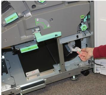
6. Ora è possibile sbloccare e rimuovere in sicurezza il cassetto del modulo di uscita. Impugnare la maniglia verde (4) del cassetto e ruotarla verso destra in posizione orizzontale. Estrarre lentamente il blocco del cassetto fino al punto di arresto.
