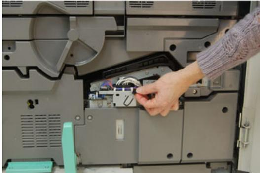
8. Posizionare il coperchio posteriore del fusore sul gruppo e avvitare bene la vite.
