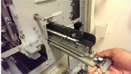
5. Riporre correttamente lo stampo di perforazione rimosso nello spazio di stoccaggio degli stampi di perforazione nel dispositivo AdvancedPunch Pro.
