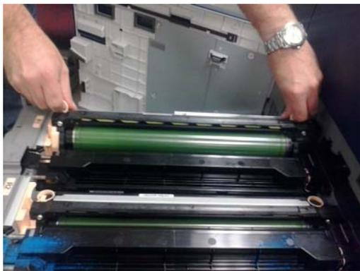
**9. Simultaneamente** abbassare entrambe le estremità della cartuccia del fotoricettore per inserirla in posizione **orizzontale**.
