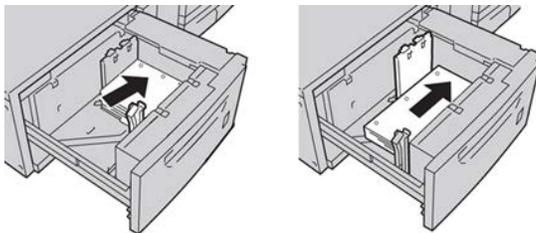
7. Ajuste as guias do papel pressionando a trava da guia e movendo a Guia da borda cuidadosamente até que ela encoste levemente na borda do material na bandeja.
