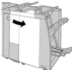
3. Localize o Recipiente de sobras de grampos (R5) no módulo de acabamento e mova a alavanca de travamento para a posição destravada.
