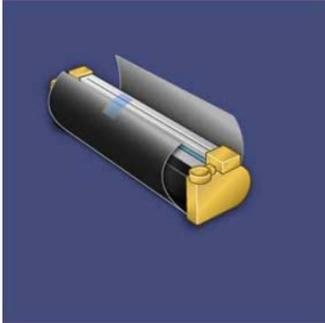
5. Retire a folha que cobre o novo cartucho do fotorreceptor e coloque-a embaixo do cartucho. Alguns cartuchos do fotorreceptor podem incluir uma película protetora. Remova a película do cartucho do fotorreceptor, se houver.
