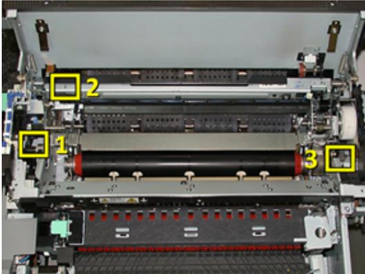
1. Coloque as Alças do módulo da correia do fusor em cada lado da correia e insira novamente o Módulo da correia do fusor necessário no Conjunto do fusor.
