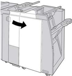
3. Remova a bandeja de saída do dobrador (**2d**), vire a alavanca **2e** para a direita e remova o papel atolado.
