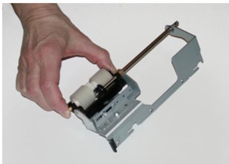
10. Reinstale o conjunto de retardo na bandeja. Alinhe os orifícios nos cortes do conjunto com a estrutura da bandeja para que os orifícios dos pinos combinem. Insira o conjunto na estrutura. Deslize o conjunto totalmente para a direita usando o pino como guia. Certifique-se de que o dispositivo esteja totalmente dentro dos entalhes e que as áreas dos 3 parafusos estão alinhadas.
