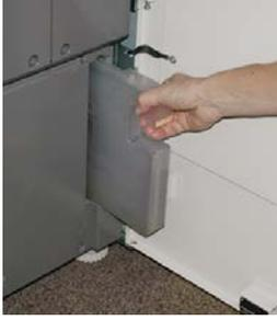
4. Segure a alça com uma mão e lentamente comece a remover o frasco de toner usado da impressora.
