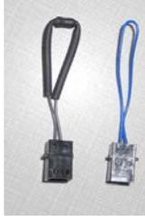
7. Conecte a ligação em ponte adequada ao conector branco exposto na parte dianteira do conjunto do fusor empurrando as duas extremidades juntas. Não há liberação. Para desconectar, basta separar.
