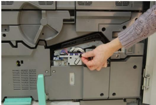
8. Posicione a tampa do fusor de volta no conjunto e aparafuse firmemente no lugar.
