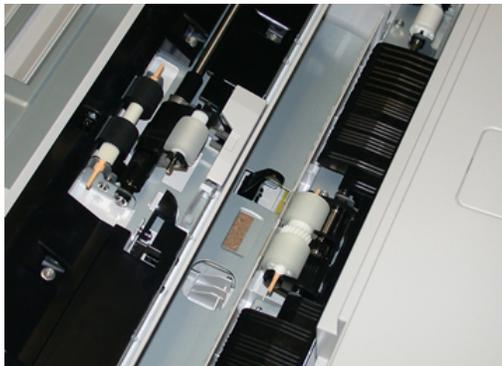
3. Retire e substitua o rolo de alimentação apertando o eixo de metal e levantando-o.
