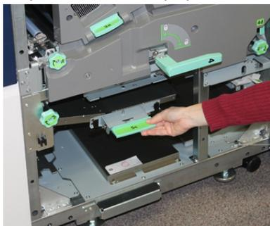
5. Na extremidade direita da impressora, localize a alavanca **5a** e o botão **5b**. Abaixe a alavanca **5a** para acessar a área do inversor e remova o papel. Gire o botão **5b** no sentido horário para avançar o papel que está entrando no inversor.
