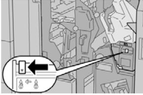
4. Pressione **R5** conforme mostrado na figura e remova o recipiente de sobras de grampos da impressora.
