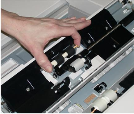
4. Retire e substitua o rolo impulsor usando a mesma técnica.
