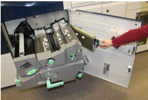
9. Segure a alça verde da gaveta (4) e empurre com cuidado o conjunto da Gaveta de saída completamente. Gire a alavanca para a esquerda para travar a gaveta no lugar.
