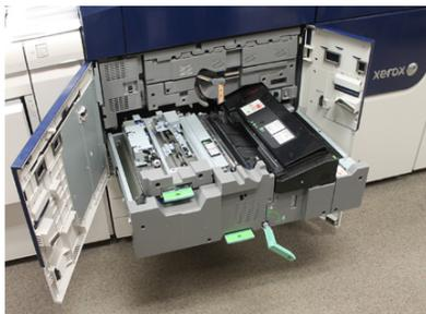
4. Quando o fusor tiver esfriado, puxe a Gaveta de transferência para a posição de eliminação de atolamento.
