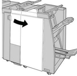
3. Remova a bandeja de saída do dobrador (2d), vire a alavanca 2g e remova o papel atolado.
