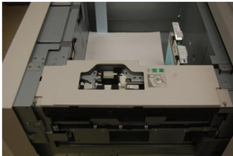
3. Remova o rolo impulsor pressionando para baixo a guia preta com uma mão (que levanta o rola para cima) e depois apertando o eixo de metal em ambas as extremidades com a outra mão. Levante o rolo impulsor.
