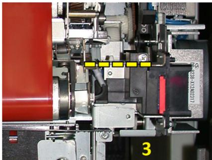
Verifique se o fusor está encaixado corretamente e completamente ou a Tampa superior do fusor não fechará e poderá resultar em dano à impressora.
