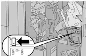
4. Pressione **R5** conforme mostrado na figura e remova o recipiente de sobras de grampos da impressora.
