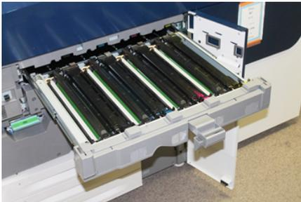
7. Remova o cartucho do fotorreceptor antigo, mantendo os anéis fornecidos em ambas as extremidades do cartucho do fotorreceptor e levantando ligeiramente.
