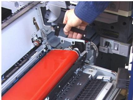
12. De frente para o lado direito da gaveta, empurre o módulo ligeiramente para longe de você e erga a Correia do fusor para cima e para longe da impressora, deixando o peso do módulo em suas mãos.
