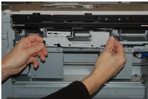
7. Com o conjunto de retardo fora, acesse e remova o rolo de alimentação. Para removê-lo, aperte as duas extremidades do eixo de metal e levante. Para recolocar, aperte as duas extremidades do eixo do novo rolo, insira e solte as extremidades do rolo nos entalhes.
