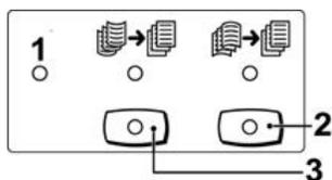
1. Botão **Automático**: quando este indicador estiver aceso, a correção de curvatura adequada é executada automaticamente, dependendo do tamanho e da orientação da saída impressa. O botão deve ser definido como Automático na maioria das situações. O botão é alternado automaticamente para o modo Automático quando:
