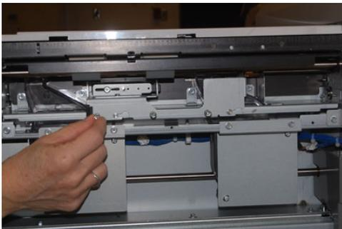
6. Deslize o conjunto de retardo totalmente para a esquerda para que fique fora dos entalhes. Puxe o conjunto para fora em sua direção até que esteja completamente removido da bandeja. Guarde-o.
