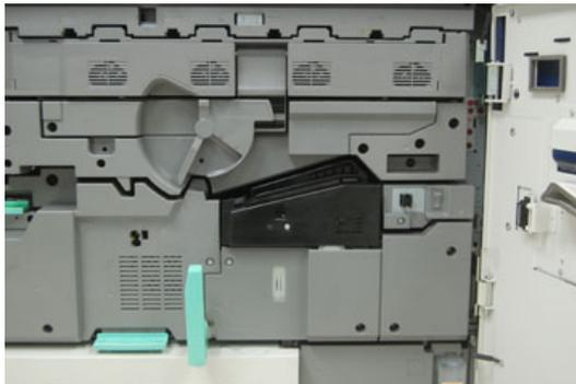
4. Retire a tampa do fusor usando a chave T10 Torx para desaparafusar o parafuso de montagem no centro da tampa.
