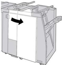
3. Remova a bandeja de saída do dobrador (2d), vire a alavanca 2g e remova o papel atolado.
