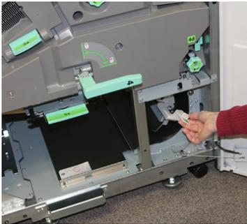
6. Теперь можно безопасно отпереть и выдвинуть секцию модуля вывода. Возьмитесь за зеленую ручку секции (4) и поверните ее вправо в горизонтальное положение. Аккуратно выдвиньте секцию до упора.
