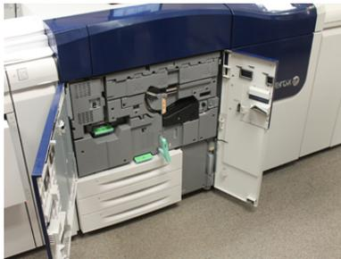
3. Найдите ручку (2) и поверните ее по часовой стрелке в горизонтальное положение, чтобы отпереть секцию переноса.
