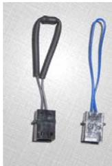
7. Присоедините соответствующую перемычку к открытому белому разъему спереди фьюзера, соединив вместе оба конца. Фиксатор не предусмотрен. Для отсоединения нужно просто потянуть концы в сторону.
