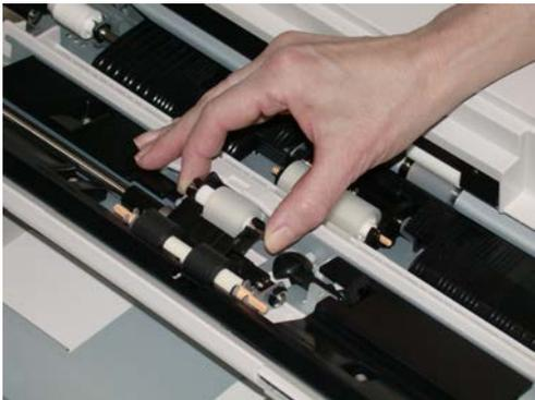
5. Точно так же снимите и замените ролик торможения.
