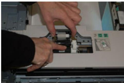
4. Установите новый ролик захвата: прижав с обоих концов металлический валик, нажмите на черный выступ и вставьте ролик в выемки.
