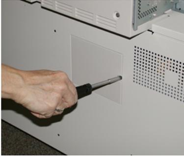
3. Вытяните и снимите крышку всасывающего фильтра.
