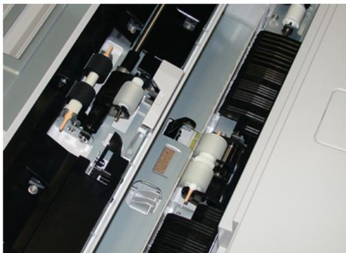
3. Сжав металлический валик, снимите ролик подачи и замените его.
