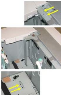
6. Затяните ручной винт так, чтобы он зафиксировал лоток для подачи открыток.
