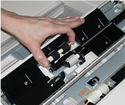
4. Точно так же снимите и замените ролик захвата.
