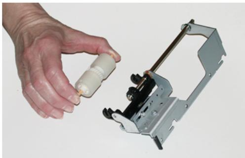
9. Точно так же вставьте в черные выемки узла новый ролик торможения.
