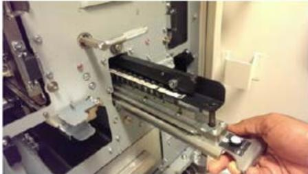
5. Уберите снятый комплект штампа в отсек для хранения на перфораторе AdvancedPunch Pro.
