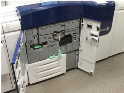
3. Откройте и выдвиньте секцию переноса, повернув зеленую ручку **2** (в середине) вправо, в горизонтальное положение. Выдвиньте секцию до упора.
