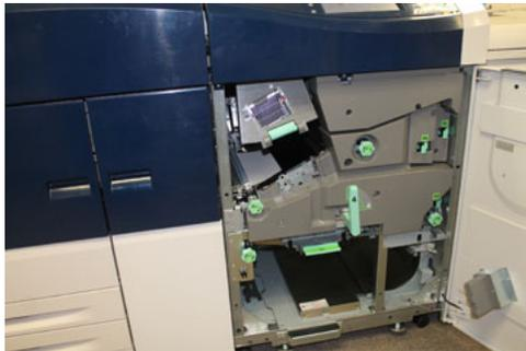
3. Для извлечения бумаги, застрявшей на участке входной перегородки (**3a** и **3b**), поднимите рычажок **3a** верхнего блока охлаждения и поверните ручку **3b** по часовой стрелке, чтобы продвинуть бумагу, застрявшую на ролике модуля ввода. Убедитесь, что бумага полностью прошла через ролик под участком ввода.
