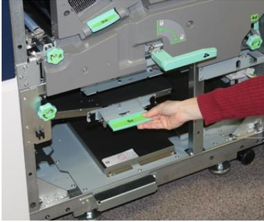
5. В крайней правой части аппарат найдите рычажок **5a** и ручку **5b**. Опустите рычажок **5a** для доступа к участку инвертора и извлеките бумагу. Поверните ручку **5b** по часовой стрелке, чтобы продвинуть бумагу на входе в инвертор.
