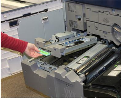
5. Если бумага застряла в верхней части модуля переноса, извлеките ее с ролика регистрации (участок **2a**), вытянув в направлении «прямо».
