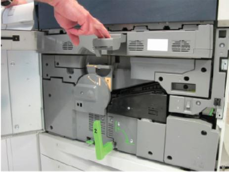
⚠ Importante: Para proteger al fotorreceptor de la luz, cubra el cartucho del cilindro con la caja de protección del cilindro dentro del plazo de 30 segundos.
