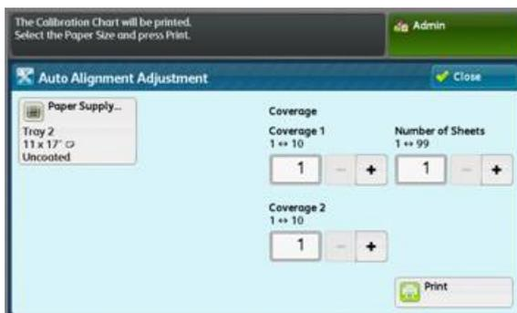
**Cobertura 1** es para la cara 1 y **Cobertura 2** es para la cara 2. Puede dejar configurada la cobertura 1. Sin embargo, si se repiten los problemas de alineación en los trabajos de impresión con una área de cobertura alta, puede ir aumentando este valor hasta 10.
