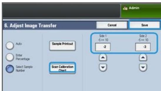
37. Ya puede imprimir una muestra para ver los resultados del ajuste o puede guardar los resultados. Para imprimir una muestra, toque **Impresión de muestra** y pulse el botón verde **Comenzar** en el panel de control. Toque **Confirmar** después de imprimir las muestras y, a continuación, **Cerrar**. Para evaluar la muestra, verifique los parches de color de la fila marcada con un 0.
