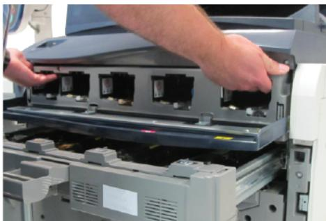
4. Riporre il complessivo erogatore del toner nel cassetto superiore del carrello di servizio.
