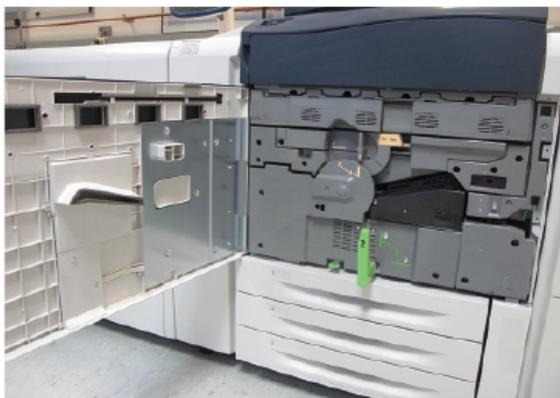
3. Ruotare e girare la maniglia **R1-R4** del cassetto fotoricettori nella posizione di sblocco.
