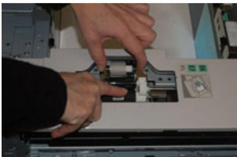
4. Sostituire il nuovo rullo stringendo entrambe le estremità dell'albero metallico e spingendo in basso la linguetta nera, inserire e rilasciare le estremità del rullo negli incastri.
