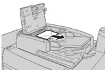
4. Se vengono visualizzate istruzioni che richiedono di aprire la copertura interna, sollevare la leva e aprire la copertura interna. Rimuovere il documento inceppato.
