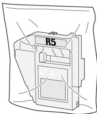
5. Inserire il nuovo contenitore dei punti metallici di scarto abbassandolo nell'alloggiamento e poi spingendolo con la mano per bloccarlo in sede.
