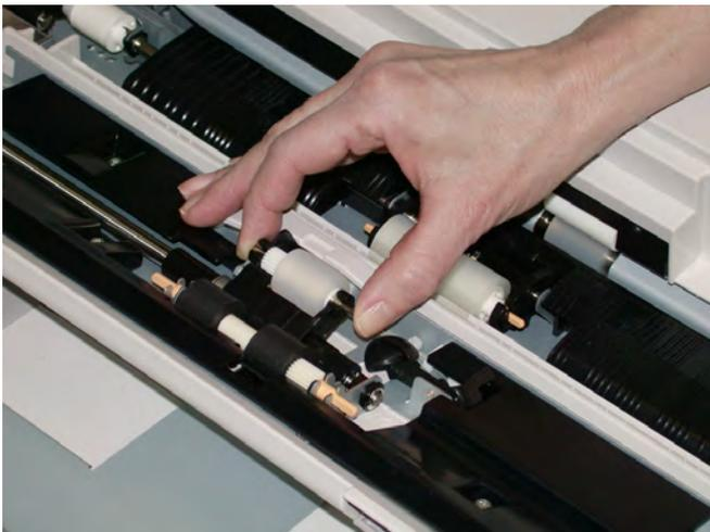
5. Remova e substitua o rolo separador utilizando a mesma técnica.
