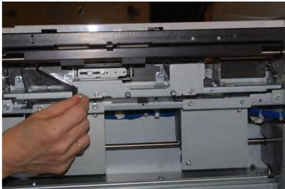
6. Deslize o conjunto do separador totalmente para a esquerda para que fique fora dos entalhes. Puxe o conjunto para fora em sua direção até que esteja completamente removido da bandeja. Guarde-o.
