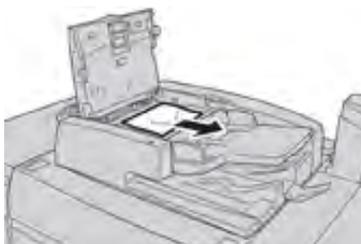
4. Se for instruído a abrir a tampa interna, levante a alavanca e abra a tampa interna. Remova o documento atolado.
