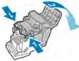
6. Para remover o refil de grampos, pressione a parte traseira do recipiente do refil como mostra a figura.
