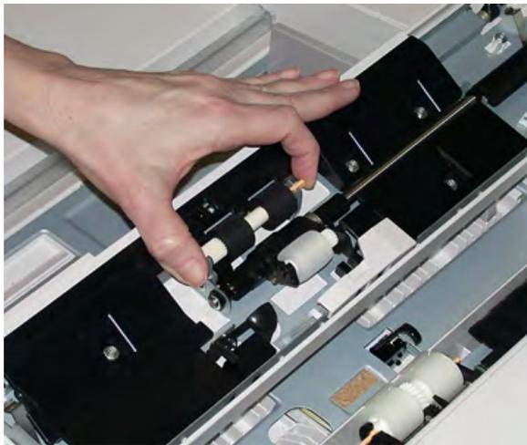
4. Remova e substitua o rolo ejetor utilizando a mesma técnica.
