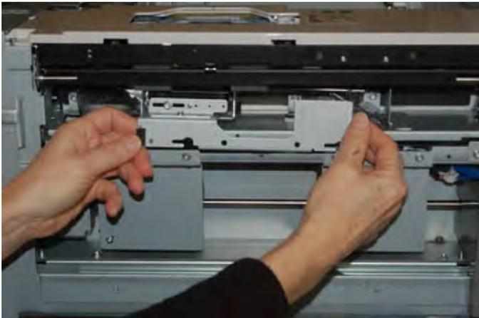
7. Quando o conjunto do rolo separador estiver para fora, acesse e remova o rolo de alimentação. Para removê-lo, aperte as duas extremidades do eixo de metal e levante. Para recolocar, aperte as duas extremidades do eixo do novo rolo, insira e solte as extremidades do rolo nos entalhes.
