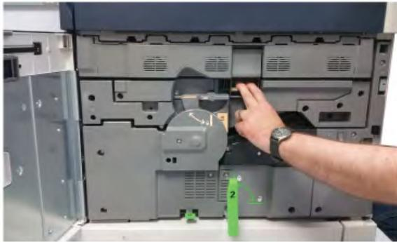
7. Remova o cartucho do fotorreceptor antigo, mantendo os anéis fornecidos em ambas as extremidades do cartucho do fotorreceptor e levantando ligeiramente.
