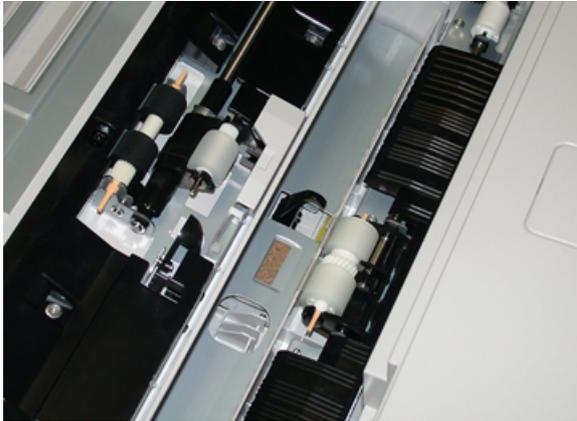
3. Remova e substitua o rolo de alimentação apertando o eixo de metal e removendo-o.
