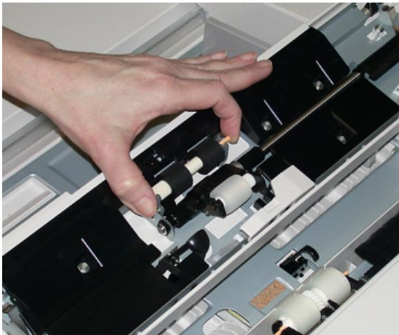
4. Remova e substitua o rolo ejetor utilizando a mesma técnica.
