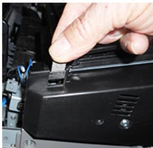
9. Mit dem T10 Torx-Schraubenzieher entfernen Sie eine Schraube und die vordere Abdeckung des Fixierers.
