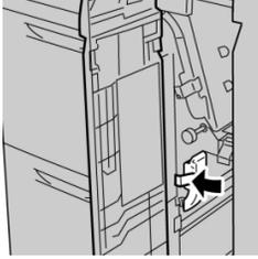
4. Die vordere Abdeckung des Zufuhrmoduls schließen.
