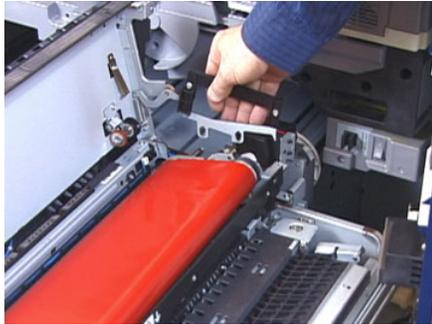
14. Drehen Sie die rechte Seite des Fachs zu sich hin, drücken Sie das Modul leicht weg und heben Sie das Fixierband hoch und aus der Druckmaschine heraus.
