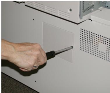
3. Die Ansaugfilterabdeckung herausziehen und entfernen.
