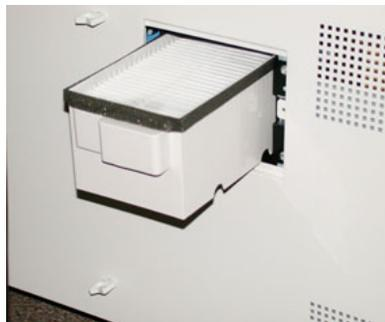
5. Den Ansaugfilter aus dem Gehäuse entfernen.
