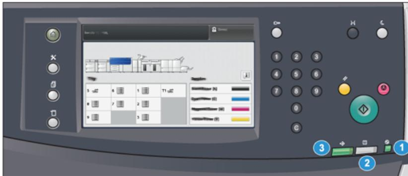
Auf der Druckmaschine befinden sich drei Statusleuchten direkt unter dem Steuerpult. Von rechts nach links:
