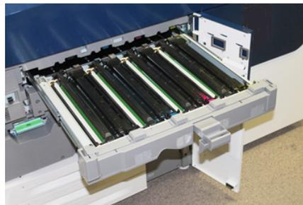
5. Entfernen Sie die alte Trommeleinheit, indem Sie Ihre Finger durch die Fingerringe an beiden Enden der Einheit stecken und sie sanft anheben.
