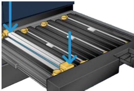
11. Schließen Sie das Fach mit der Trommeleinheit sofort, um die anderen Trommeln vor Licht zu schützen.
