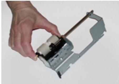
**6. Vuelva a instalar el conjunto del rodillo separador en la bandeja.**
