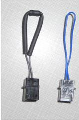
7. Raccorder le cavalier approprié au raccord blanc exposé à l'avant du module four en reliant les deux extrémités. Il n'y a aucune relâche. Pour déconnecter, tirer pour les séparer.
