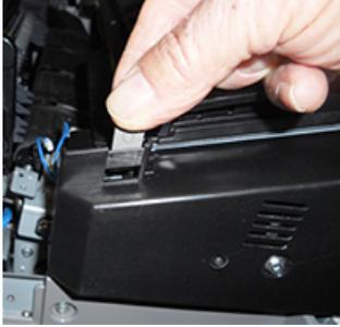
6. Localiser les deux raccords du circuit de dérivation dans le kit. Le cavalier de résistance noir (à gauche) est utilisé pour la valeur de plage 2 et le cavalier bleu (à droite) représente la valeur de plage 3. Pour obtenir les numéros de plage, se reporter au tableau du connecteur du départ manuel dans [Renseignements sur la largeur du papier du module four](#).
