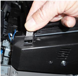
9. En utilisant la clé T10 Torx fournie, retirer une vis et le panneau avant du module four.
