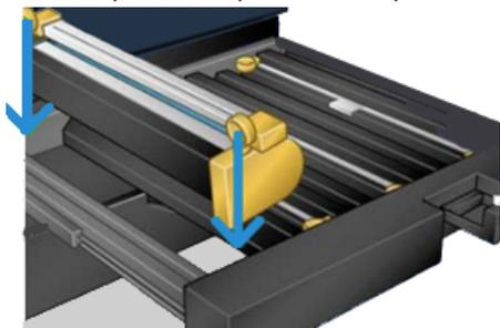
10. Appuyer sur les deux extrémités de le module photorécepteur pour la placer en position horizontale.
