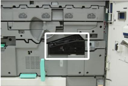
Vérifier la présence d'un clip identifiant la largeur du four noir ou gris à l'avant gauche du panneau. Le clip identifie la largeur du four actuellement installé, comme 13 pouces. Si aucun clip ou cavalier n'est raccordé (c'est l'installation par défaut), cela signifie que le four standard est installé. Il permet de traiter toutes les largeurs de papier.
