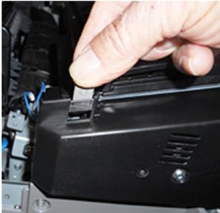
6. Individuare i due connettori bypass del fusore nel kit. Il ponticello del resistore nero (sinistro) è usato per la gamma di valori 2 e il ponticello del resistore blu (destro) è usato per la gamma di valori 3. Per i numeri della gamma, consultare la tabella [Connettore bypass](#) nella sezione [Informazioni sulla larghezza carta per il fusore.](#)
