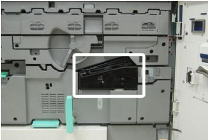
Verificare la presenza di un identificatore larghezza fusibile nero o grigio nella parte frontale sinistra del coperchio. La clip identifica la larghezza del fusore attualmente installato, per esempio 13 pollici. Se la clip e il jumper non sono collegati come da configurazione predefinita, significa che è installato il fusore standard compatibile con carta di tutte le larghezze.
