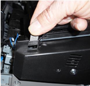
9. Usando il cacciavite Torx T10 in dotazione, rimuovere una vite e la copertura anteriore del fusore.
