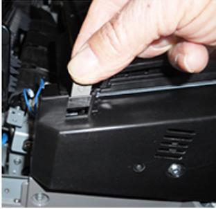
6. Locate the two bypass fuser connectors in the kit. The black resistor jumper (left) is used for the number 2 range value and the blue jumper (right) represents the number 3 range value. Para obter os números de faixas, consulte a tabela Conector manual em [Informações sobre a largura do papel do fusor](#).
