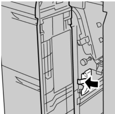
4. Die vordere Abdeckung des Zufuhrmoduls schließen.
