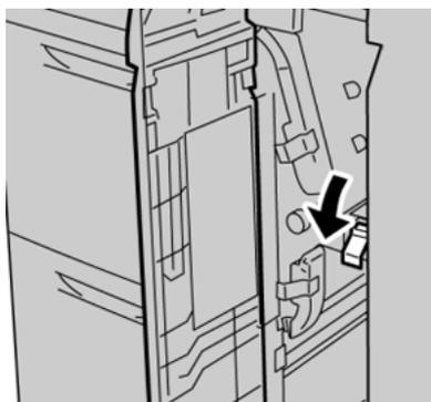
5. Die vordere Abdeckung des Zufuhrmoduls schließen.
