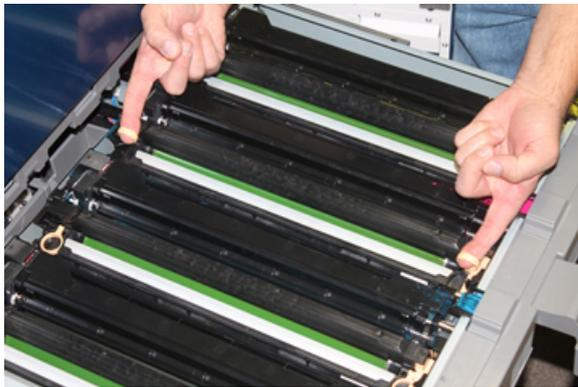
**!** **Attention :** Les modules photorécepteurs sont sensibles à la lumière. Ne laissez pas le tiroir des modules photorécepteurs ouvert pendant plus d'une minute lors du remplacement des modules. L'exposition des modules photorécepteurs à la lumière directe du soleil ou à un éclairage intérieur fluorescent de forte intensité pendant plus d'une minute pourrait nuire à la qualité image.
